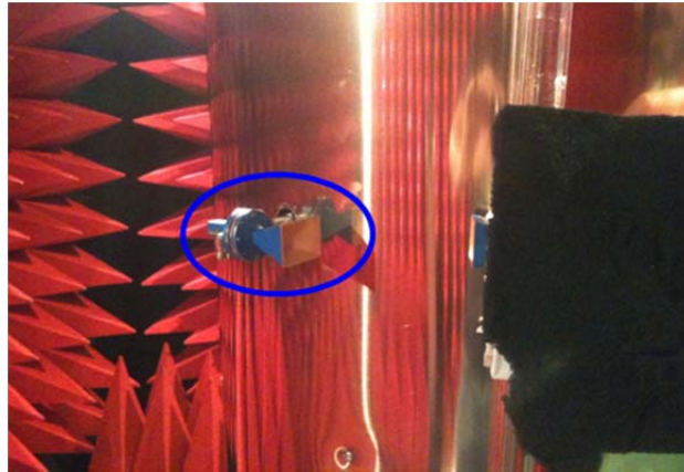
Figure 2.3 Antenne cornet pyramidal utilisé pour les mesures BANs dans les précédents travaux [60].
