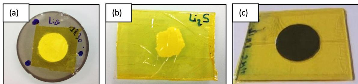
Figure II-2. Photographies de la préparation des échantillons de poudres (a), (b) et d'électrodes (c) protégées par un film Kapton® et analysées par DRX.
