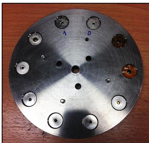
Figure V-4. Photographie de la platine, support des échantillons de standards.
