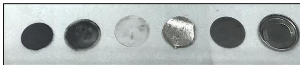
FigureIV-23. Photographie d'une pile bouton Li<sub>2</sub>S « réduction »/Li démontée en fin de première charge (et chargée jusqu'à un potentiel de 3,6 V *vs* Li<sup>+</sup>/Li).
