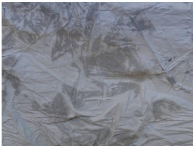
**Figure 3.7 – Aspect d'un chiffon après utilisation en fin de finition du nettoyage. Les traces sombres sont un mélange de plastifiant et de propergol.**
