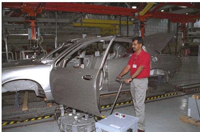
**Figure 1.1 – Premier prototype de cobot industriel introduit chez General Motors pour assister les opérateurs au déchargement de portières de voitures [WAPC98].**
