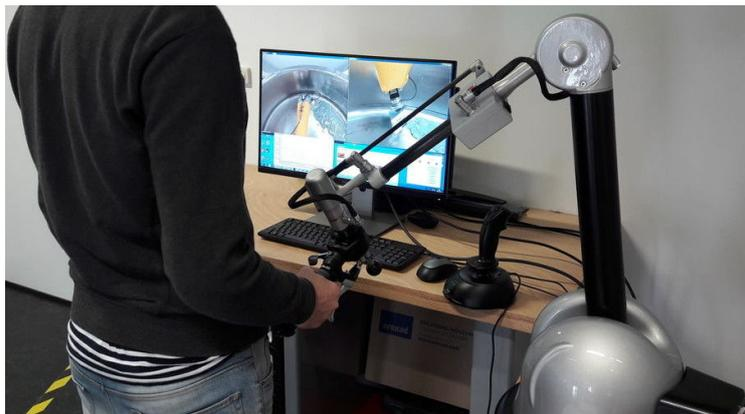
Figure 4.40 – Illustration du pilotage du robot avec le dispositif haptique.
