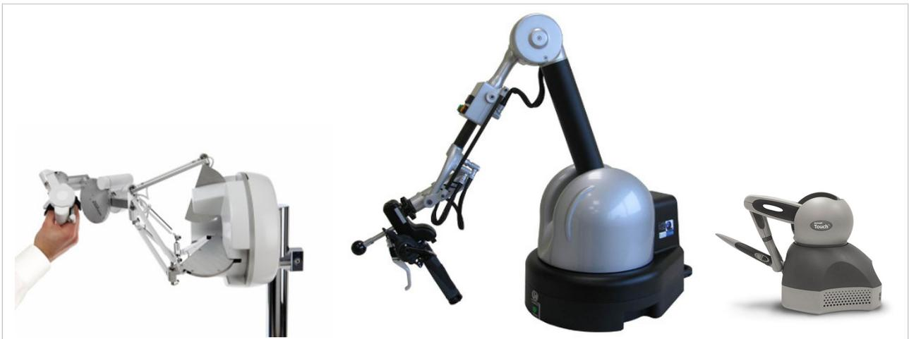
Figure 4.12 – Bras haptiques commercialisés : sigma.7 de Force Dimension (à gauche), Virtuose 6D TAO d'Haption (au milieu) et Geomagic Touch de 3D Systems (à droite).
