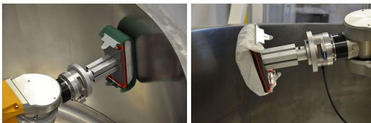
Figure 4.29 – Effecteurs de grattage (à gauche) et de finition (à droite).
