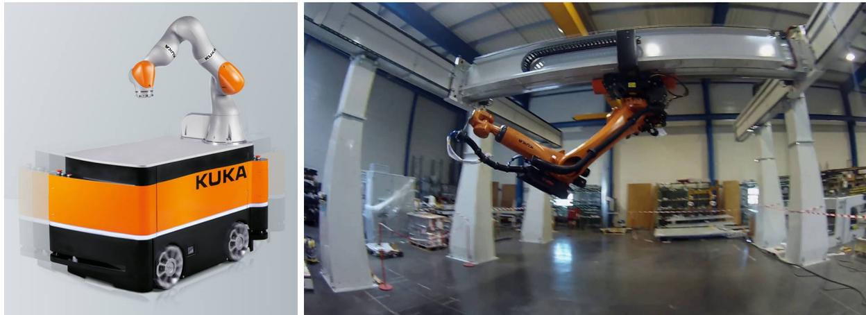
Figure 2.2 – À gauche, le Kuka KMR iiwa, un robot industriel articulé monté sur un robot mobile. À droite, un robot industriel articulé monté sur des axes linéaires du constructeur Lucas France.
