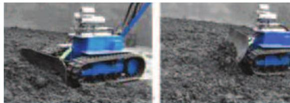
Figure 3.11 – Robot de nettoyage de résidus dans une cuve de pétrole, repris de Deng et al. [DXLZ10].
