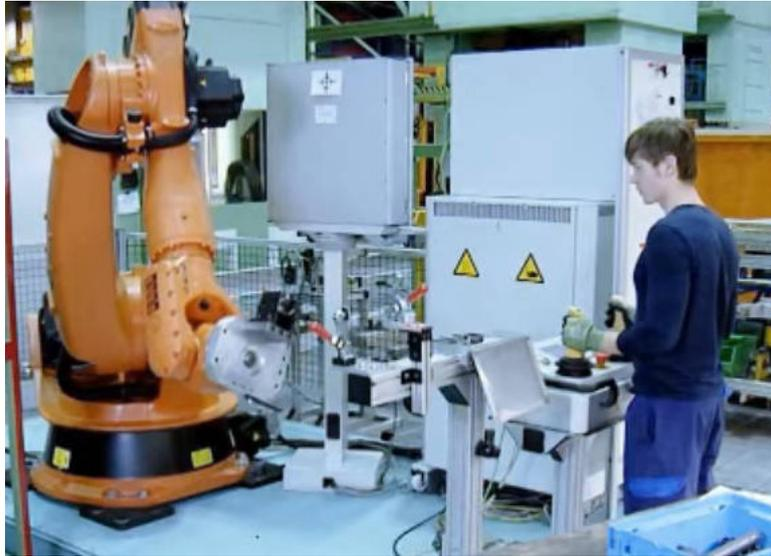
Figure 4.13 – Commande d'un robot industriel à l'aide de joysticks, par la société MRK-Systeme.
