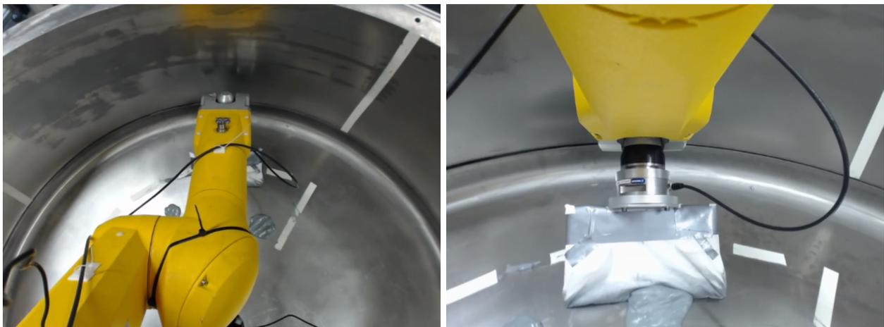
**Figure 4.37 – Vues caméras retenues pour les essais de supervision et de téléopération avec les opérateurs : "vue cuve" sur l'axe 1 du robot à gauche et "vue outil" sous l'axe 3 du robot à droite.**
