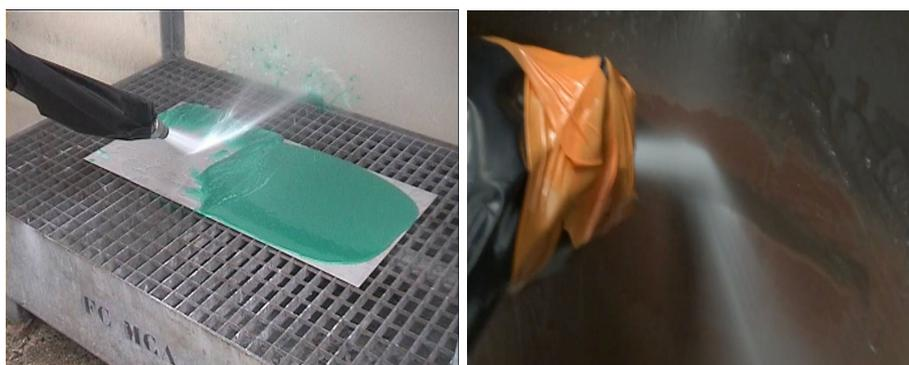
Figure 3.2 – Essais d'hydrogommage sur plaque avec du produit inerte (à gauche), et sur cuve de propergol en Guyane (à droite).
