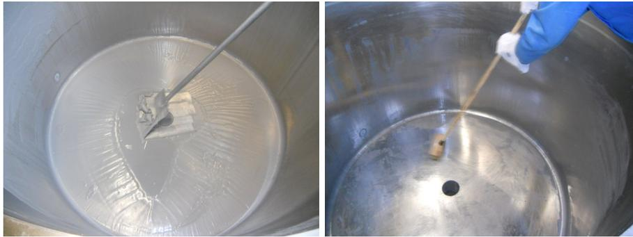
**Figure 3.5 – Photos du raclage (à gauche) et du grattage (à droite), du propergol dans une cuve à Saint-Médard.**
