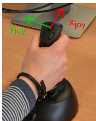
Figure 4.17 – Direction des axes  $x_{joy}$  et  $y_{joy}$  du joystick.
