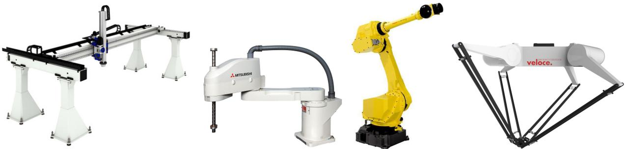
**Figure 2.1** – Types de robots industriels classés suivant leur structure mécanique : de gauche à droite, cartésien, SCARA, articulé et parallèle.
