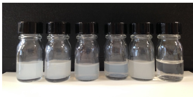
Figure 9 – De gauche à droite : 0,05 mL/min, 0,5 mL/min, 2,0 mL/min, 5,0 mL/min, 7,5 mL/min, et injection instantanée
