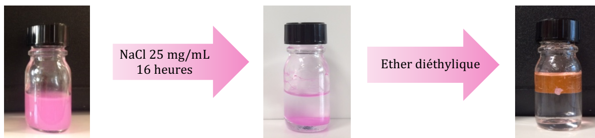
Figure 18 – Mise en évidence du relargage du Rouge du Nil par ajout de chlorure de sodium. Gauche : suspension p(MAM 80 -MASG 20 ) BM -NR/E@T ; Centre : déstabilisation de la suspension après ajout de NaCl ; Droite : précipitation du p(MAM 80 -MASG 20 ) BM après l'ajout d'éther diéthylique.
