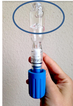
Figure 1 - Phénomène de gélification du milieu réactionnel lors de la polymérisation de MASG
