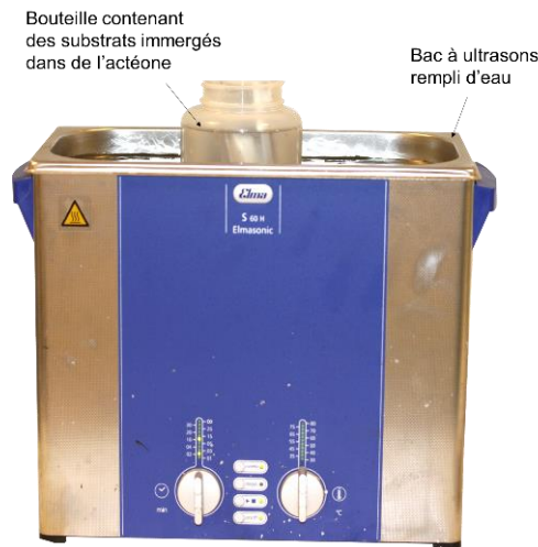
Figure 2.6. Dégraissage des substrats dans un bain à ultrasons
