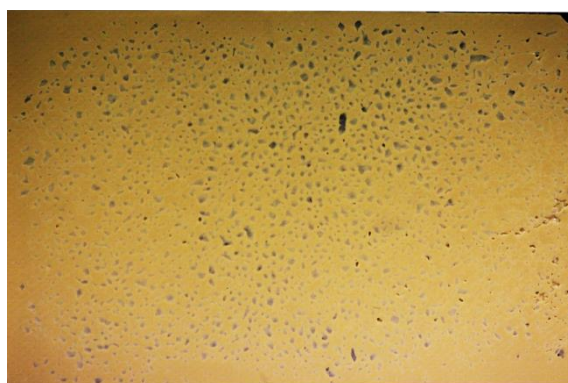
Figure 2.5. Adhésif réticulé avec un manque de pression du vide
