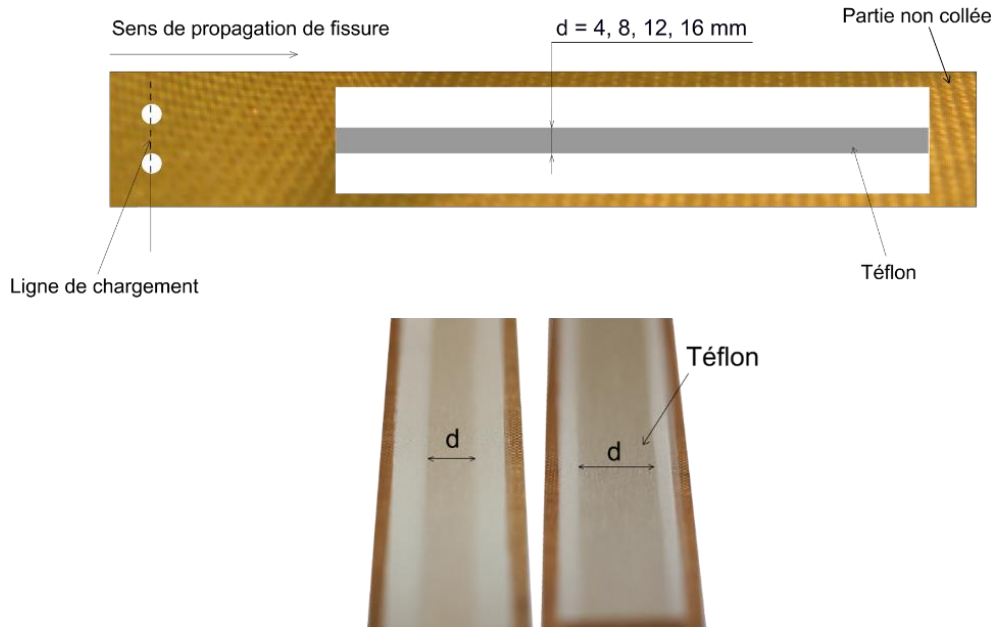
Figure 3.5. Configurations de défauts longitudinaux étudiés de largeur d = 4, 8, 12 et 16\text{mm} .
