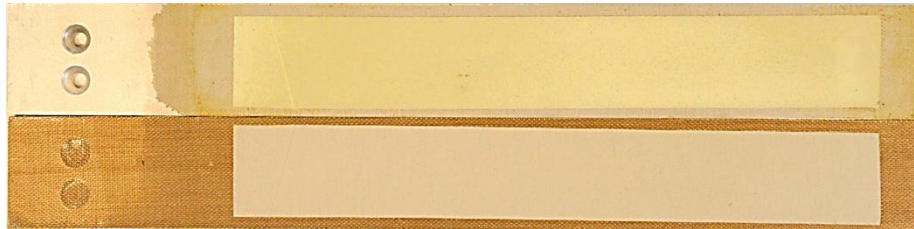
Figure 3.4 : Surface de rupture d'une éprouvette à interface faible
