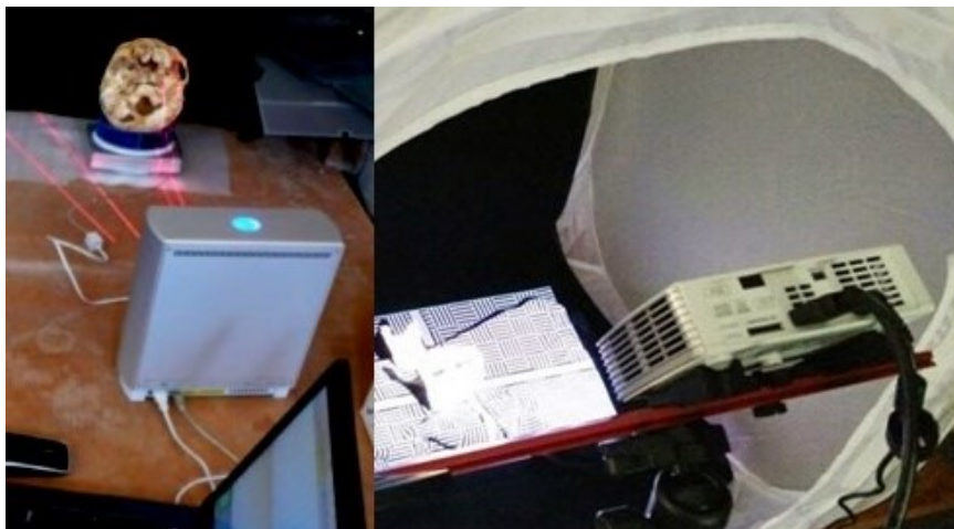
Figure 26 : Numérisation d'éléments osseux avec un scanner surfacique NextEngine (à gauche, photographie : M. Samsel) et un scanner surfacique DAVID SLS-2 (à droite, photographie : V. S. Sparacello).
