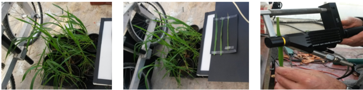
Figure 4.1 – Expérimentation en conditions réelles sur des feuilles de blé cultivées en pot Gauche: Pot focal entouré de 6 pots. Milieu: Trois feuilles individuelles enlevées du pot focal et posées sur un papier noir. Droite: Mesure en teneur d'azote en 4 points différents le long de chaque feuille
