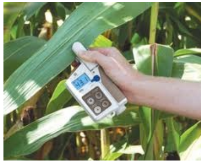
Figure 1.14 – Chlorophylle-Mètre SPAD 502 PLUS à pince ( https://www.kosmos.com.mx/tienda/catalog/minolta-spad-502-plus-meter-p-1648.html?language=en )
