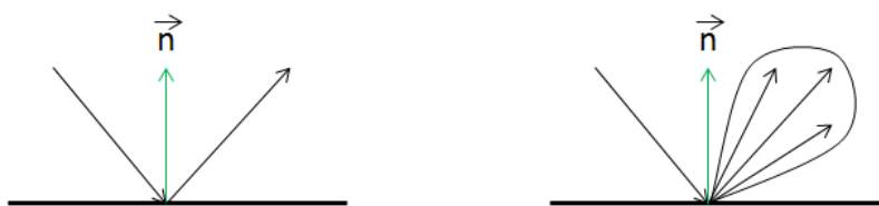
Figure 1.5 – a: Réflexion spéculaire idéale. b: Lobe spéculaire
