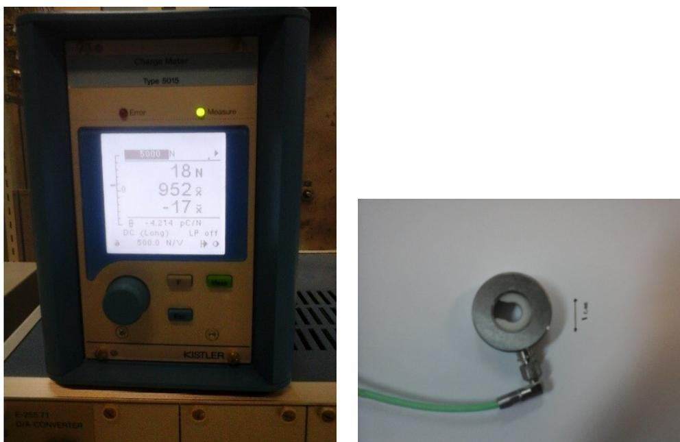
FIGURE D.2 – Conditionneur “KISTLER 5015A1000” , Capteur de force “KISTLER 9021A”.
