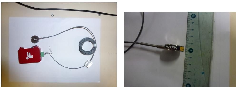
FIGURE D.3 – Capteur de force “Futek” branché avec un conditionneur de signal “Futek IAA100”.
