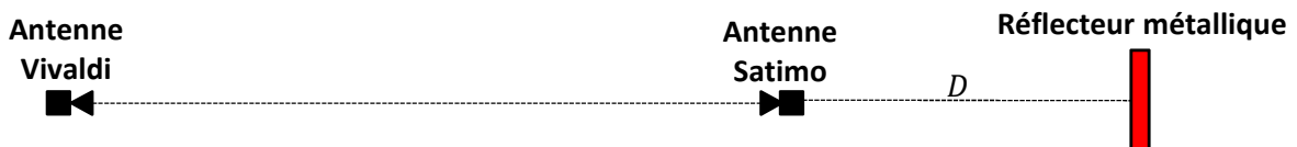
FIGURE 4.10 – Scénario 1 : réflexion par un réflecteur métallique.
