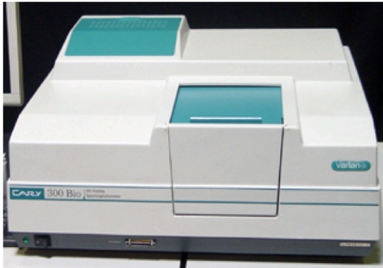
Figure 27 : Spectrophotomètres utilisés pour l'acquisition des spectres d'absorption
