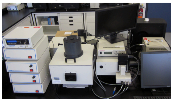
Figure 28 : Fluorimètres utilisés pour les mesures steady-state
