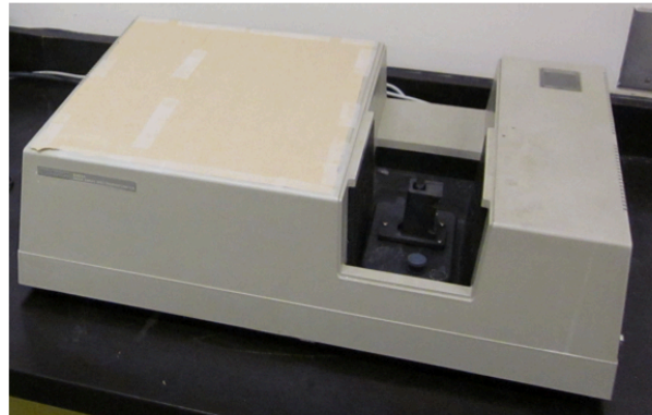
Figure 27 : Spectrophotomètres utilisés pour l'acquisition des spectres d'absorption
