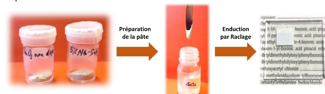
Figure 165 – Illustration des étapes de préparation des électrodes de \text{SnO}_2 et \text{SnO}_2 dopés.
