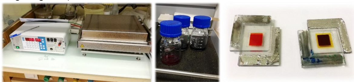
Figure 102 – Illustrations du processus de fabrication d'une cellule solaire à colorant. Frittage des électrodes sur une plaque chauffante à 500°C. Sensibilisation des électrodes de \text{TiO}_2 dans les bains de colorants. Electrodes scellées sans électrolyte à gauche et avec un électrolyte HI30 à droite.
