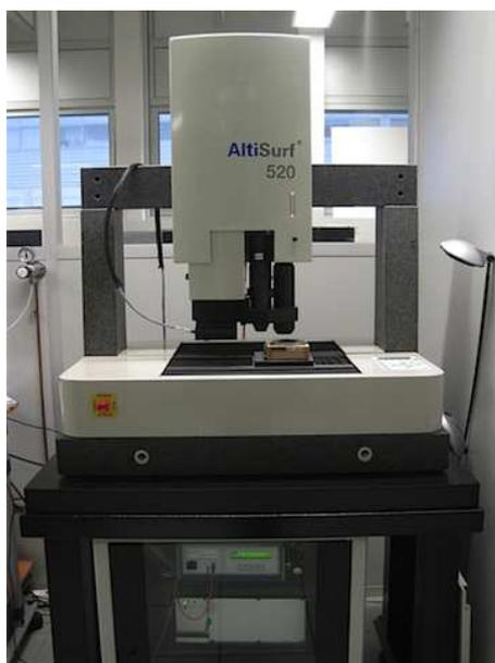
FIGURE III.15 – Rugosimètre Altisurf<sup>®</sup> 520
