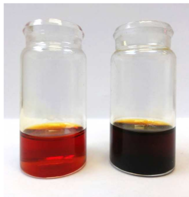
FIGURE III.3 – À gauche, le lubrifiant vierge (TV) - à droite, le lubrifiant après campagne tribologique (TU)
