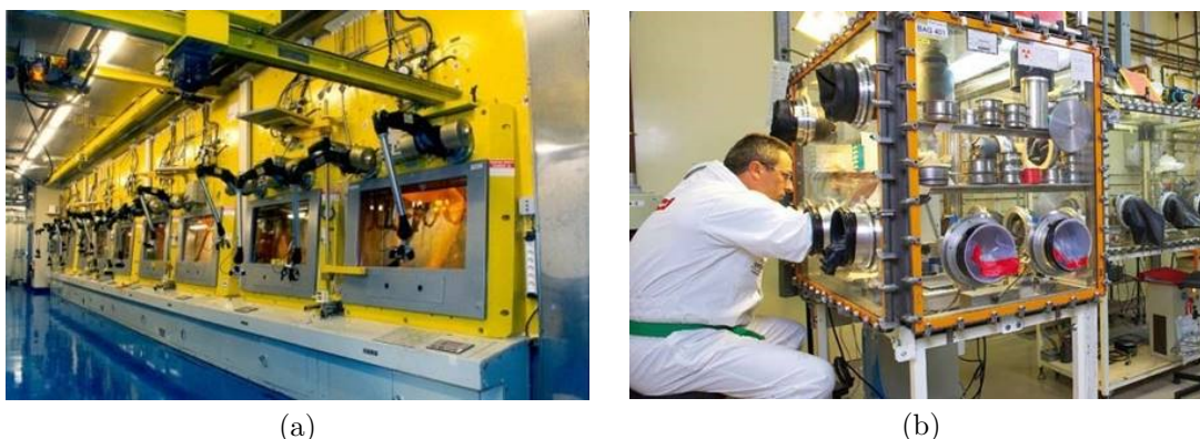
FIGURE 1.8 – Illustration des équipements de protection du SA2I pour la manipulation et l'analyse des éléments radioactifs : (a) chaîne blindée (protection contre l'irradiation) et (b) boîte-à-gants (protection contre la contamination).
