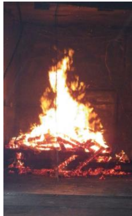
Figure 2.5 : c) Foyer de buchette effondré
