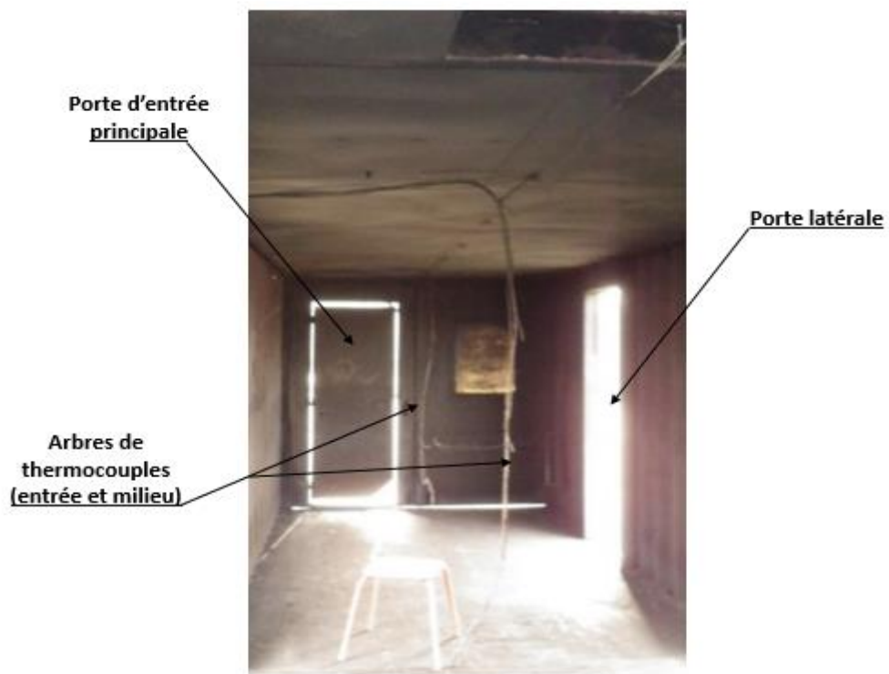
Figure 3. 14: Photo de l'intérieur du caisson prise devant le foyer
