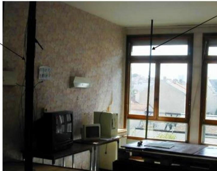
Arbre des thermocouples placés face à la fenêtre
