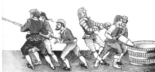
Figure 1: Seringue d'attaque du XVIème siècle
