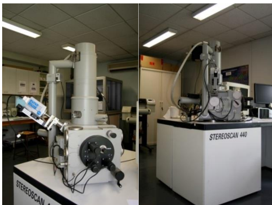
Figure IV-20 : MEB-EDS de la plateforme ASTRE (Université Savoie-Mont Blanc)
