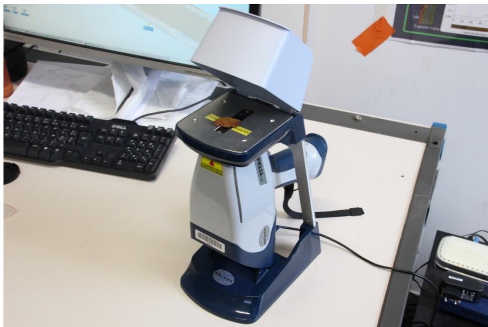
Figure IV-3 : Pistolet à fluorescence X (S1 Titan, Bruker) en configuration dite de laboratoire (© G. Castets)
