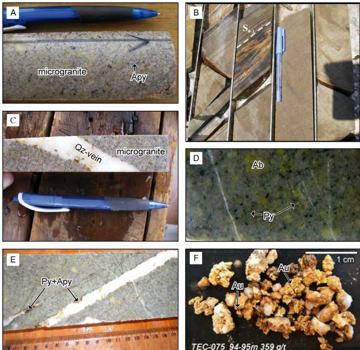
Figure 39. Echantillons représentatifs du stockwork minéralisé de Tellem.
