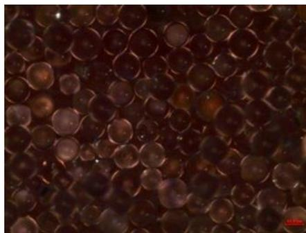
*Figure 22 : Les microbilles de verre à l'échelle microscopique (x50)*
