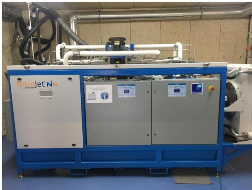
*Figure 10 : Source d'excitation thermique NitroJet N4 (CRITT-TJF&U de Bar le Duc)*
