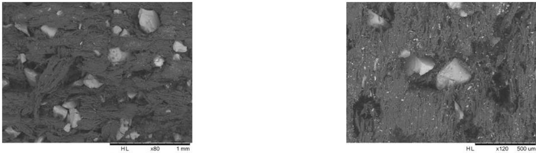
*Figure 40 : Images par microscopie électronique à balayage d'un échantillon de bois de sapin traité avec du Grenat avec un zoom respectivement de 80 et de 120*
