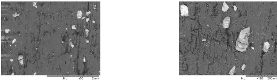
*Figure 39 : Images par microscopie électronique à balayage d'un échantillon de bois de hêtre traité avec du Grenat avec un zoom respectivement de 50 et de 120*
