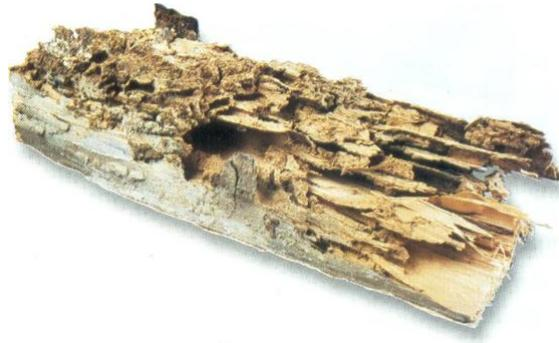
*Figure 8 : Dégâts des termites sur le bois*
