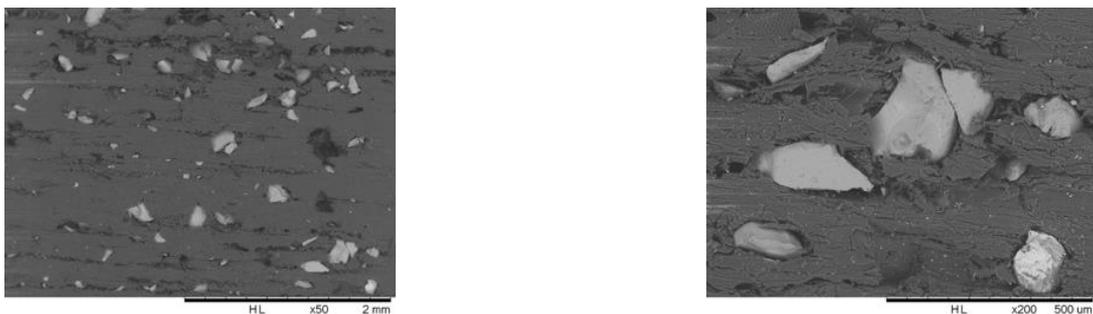
*Figure 41 : Images par microscopie électronique à balayage d'un échantillon de bois de peuplier traité avec du Grenat avec un zoom respectivement de 50 et de 200*
