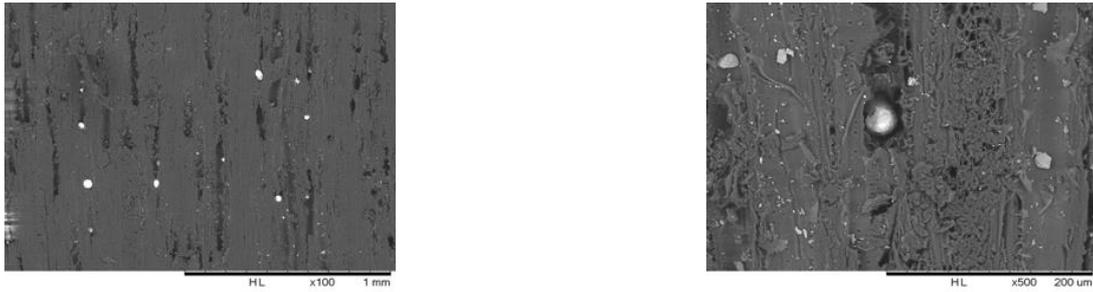
*Figure 42 : Images par microscopie électronique à balayage d'un échantillon de bois de hêtre traité avec du Cuivre avec un zoom respectivement de 100 et de 500*
