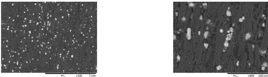
*Figure 43 : Images par microscopie électronique à balayage d'un échantillon de bois de sapin traité avec du Cuivre avec un zoom respectivement de 100 et de 400*
