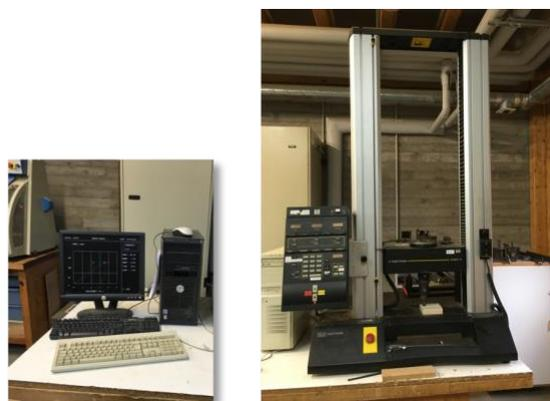
Figure 48 : Dispositif des mesures de dureté Brinell (CRITT-Bois, Epinal)
