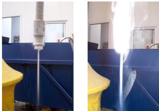
*Figure 15 : L'azote à sa sortie de la buse de projection (Laribou, 2011)*
