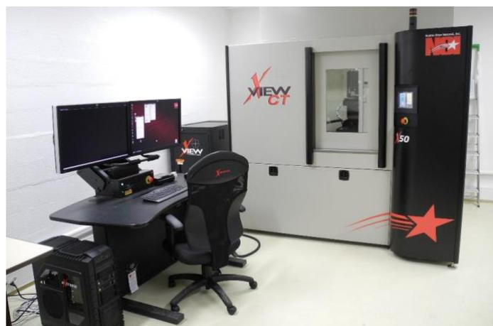
*Figure 26 : Tomographe NSI (North Star Imaging) X50+ et son environnement (Laboratoire de Mécanique et Technologie de l'ENS-Cachan)*
