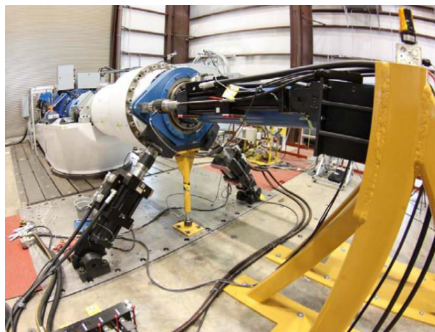
Figure I-6. Banc d'essai d'un train d'engrenages mécanique permettant de mesurer son comportement vibratoire en isolant des structures porteuses grâce à des vérins hydrauliques qui maintiennent en position le train d'engrenages et mesurent les vibrations [9].
