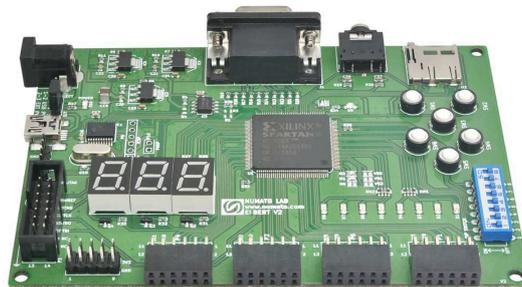
FIGURE 6.49 – Kit de développement FPGA Spartran 3A [165]
