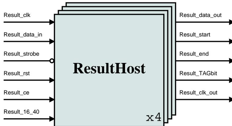
FIGURE 7.4 – Entité du contrôleur d'acquisition de résultats du circuit TDC
