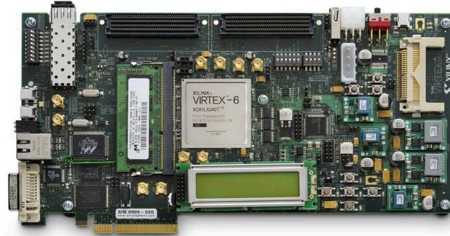
FIGURE 6.48 – Kit de développement FPGA Vertex-6
