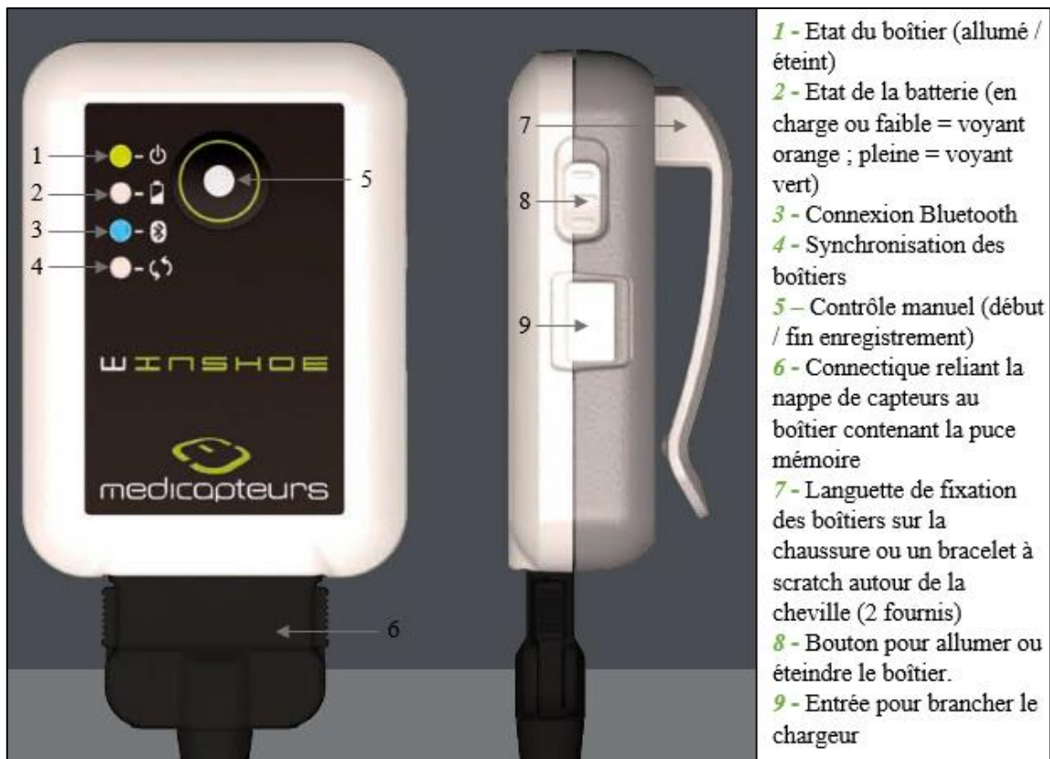
Figure 1.15 : Explication des différents boutons et voyants composant chaque boîtier
