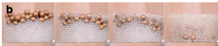
(b) Effet noix du Brésil inversé. Les grosses billes sont en bronze (masse volumique 8,9 kg/L) et les petites billes en verre. Tiré de [Breu et al. , 2003].
