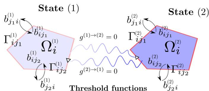
FIGURE 2.7 – Représentation schématique des états  $\Omega_i^{(1)}$  et  $\Omega_i^{(2)}$  du domaine  $\Omega_i$ . Chaque état a ses propres interfaces  $\Gamma_{\bullet}^{(1)}$  et  $\Gamma_{\bullet}^{(2)}$ , et ses propres variables d’interface  $\mathbf{b}_{\bullet}^{(1)}$  et  $\mathbf{b}_{\bullet}^{(2)}$ . Une transition d’état est déclenchée quand une fonction de seuil traverse zéro.
