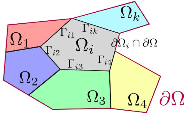
FIGURE 2.4 – Localité des données manipulées par le solveur  $\mathcal{M}_i$  du problème de couplage : les données peuvent être internes au modèle, c.a.d.  $\in \Omega_i$ , partagées entre solveurs, c.a.d.  $\in \Gamma_{ij}$ , ou des conditions limites du problème, c.a.d.  $\in \partial\Omega_i \cap \partial\Omega$ .
