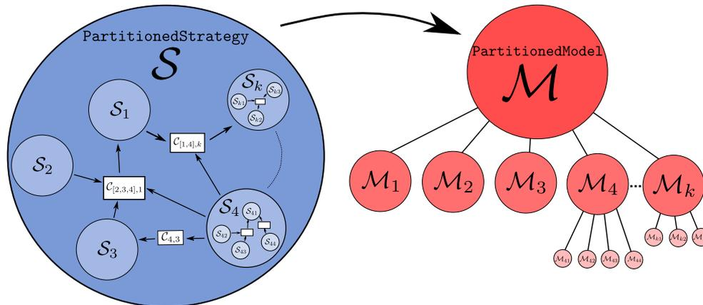
FIGURE 3.22 – Stratégie de couplage  $\mathcal{S}$  d'un modèle  $\mathcal{M}$  formant un arbre de stratégies. Chaque niveau de l'arbre correspond à un graphe composé de stratégies et de communicateurs.
