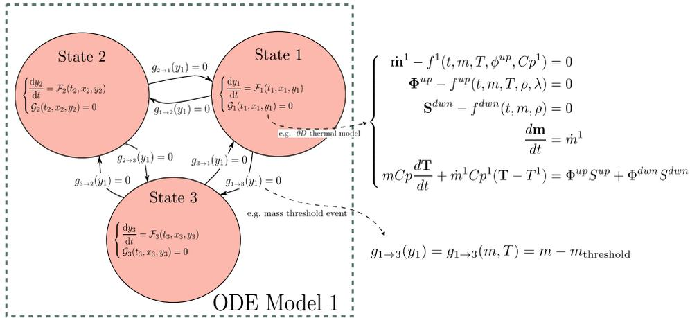
FIGURE 3.5 – Représentation schématique d'un modèle implémentant la classe `ODEModel` de PROCOR, de ses états, des équations des états (**EDO** et **EA**) et des transitions entre états (flèches en pointillés avec les fonctions de transition).
