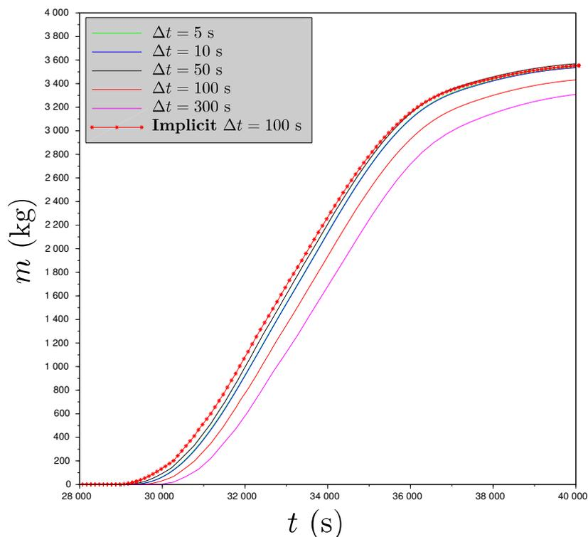
FIGURE 4.18 – Masse de cuve ablatée calculée par l'application industrielle PROCOR TransientInLowerHead pour un cas réacteur avec une résolution du couplage explicite pour différents  $\Delta t$  (courbes verte, bleue, noire, rouge et violette) et une résolution explicite/implicite (courbe rouge avec astérisques).
