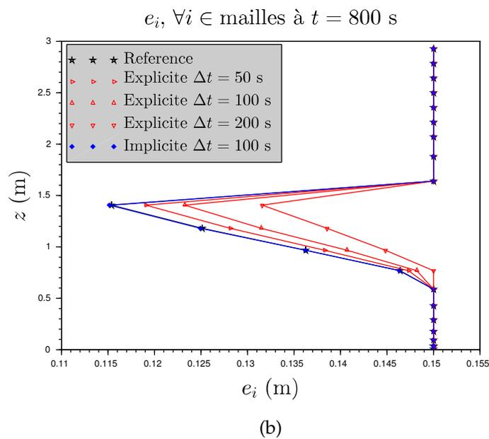
FIGURE 4.22 – **Premier cas test** : à  $t = 800 \text{ s}$ , puissances déposées sur chaque maille  $i$  par le bain de corium sur la cuve (*haut*) et épaisseurs de chaque maille  $i$  de la cuve (*bas*).
