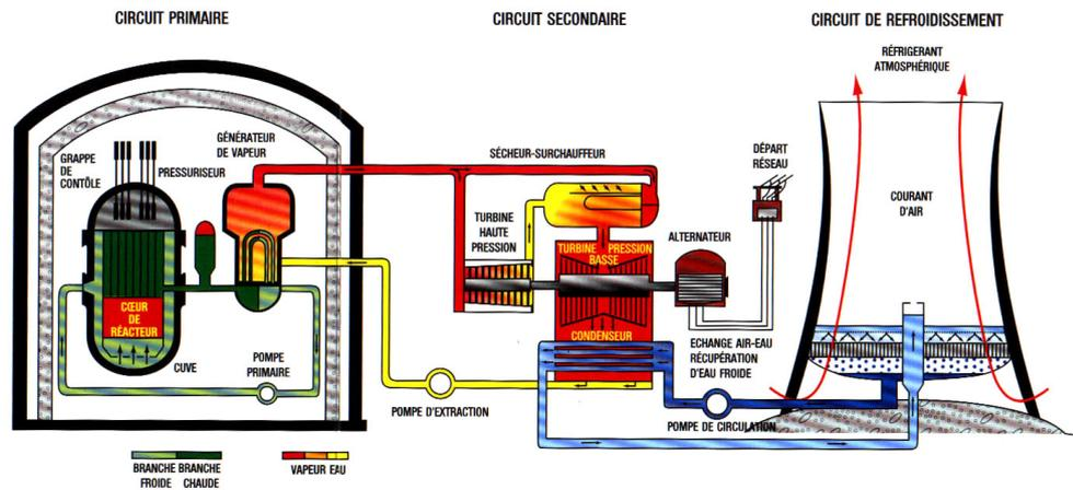
FIGURE 1.1 – Principe de fonctionnement d'un réacteur à eau pressurisée
