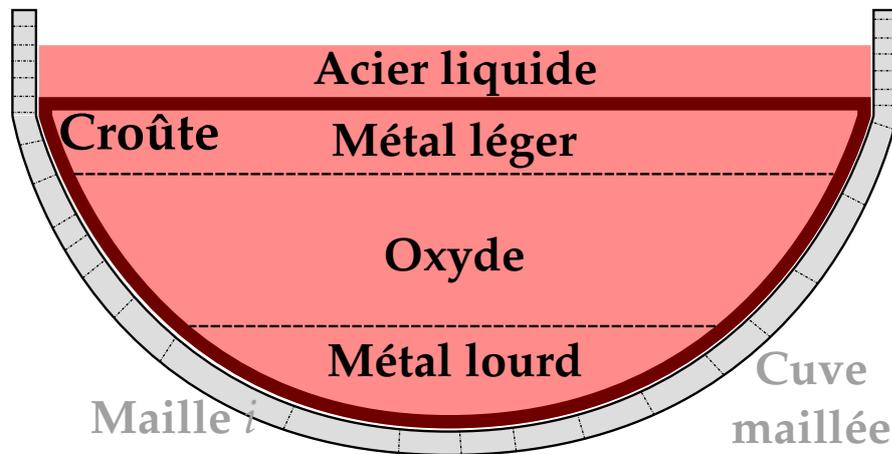
FIGURE 4.19 – Description du bain stratifié et de la cuve considérés dans l’application `TransientInLowerHead`.
