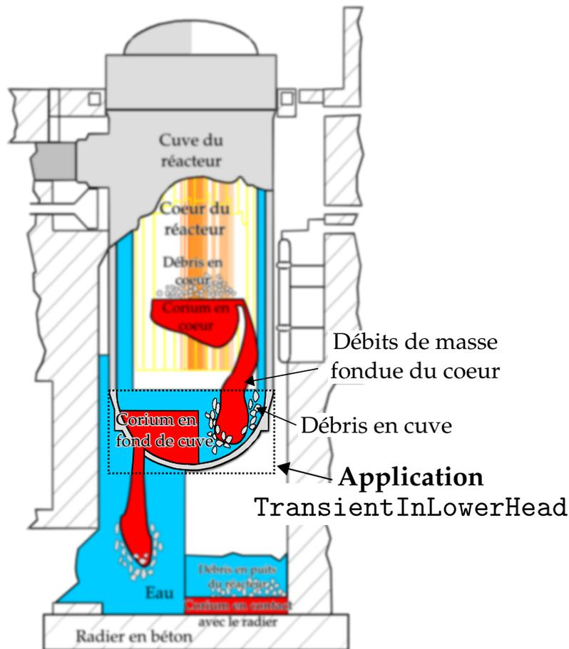
FIGURE 4.9 – L'application industrielle `TransientInLowerHead` modélise la partie non floutée de la propagation du corium dans le réacteur lors d'un accident grave, de la fonte du cœur du réacteur jusqu'à l'interaction entre le corium et le radier en béton.
