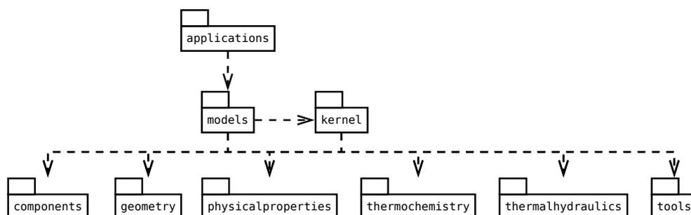
FIGURE 3.3 – Packages de la plate-forme PROCOR.
