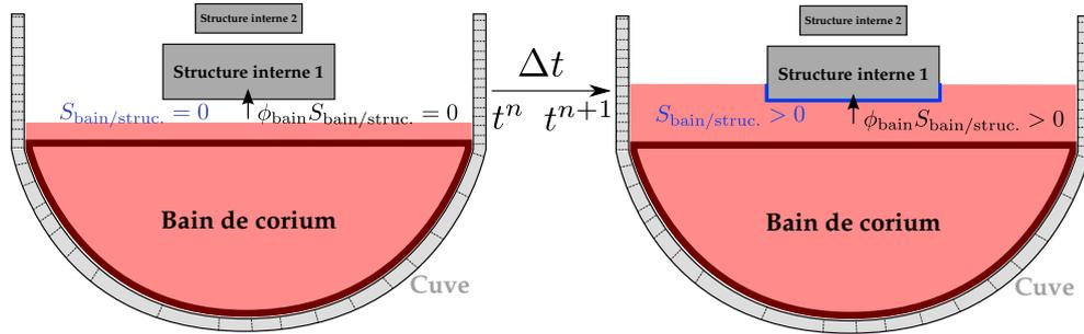
FIGURE 4.30 – Apparition d’une discontinuité sur la surface d’échange et donc dans la puissance déposée par le bain sur les structures internes lorsque celles-ci rentrent en contact avec le bain.
