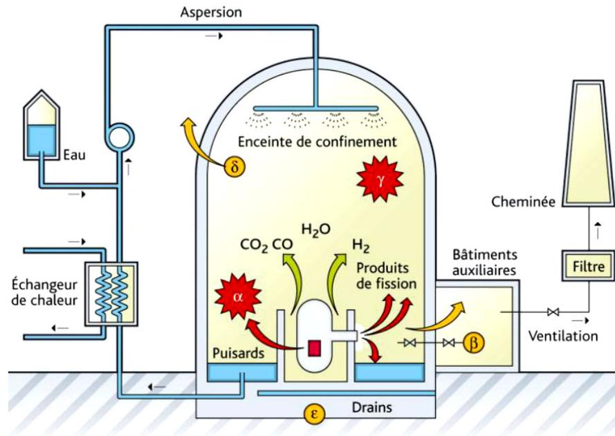
FIGURE 1.5 – Risques majeurs liés à la propagation du corium en et hors cuve.  $\alpha$  représente l'explosion de vapeur,  $\gamma$  l'explosion d'hydrogène,  $\epsilon$  l'interaction corium béton (extrait de <http://www.irsn.fr>).
