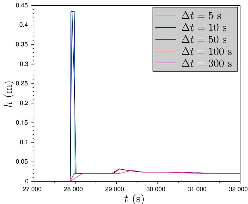
FIGURE 4.14 – Hauteur du lit de débris supérieur lors d'un cas réacteur calculée dans l'ancienne version de l'application industrielle PROCOR `TransientInLowerHead` avec un modèle stationnaire hors de son domaine de validité pour des macro pas de temps faibles ( $\Delta t \leq 10$  s).
