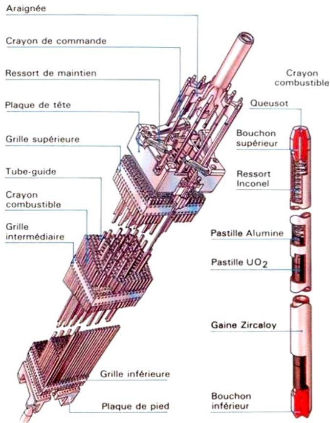
FIGURE 1.2 – Assemblage combustible (gauche) et crayon combustible (droite)
