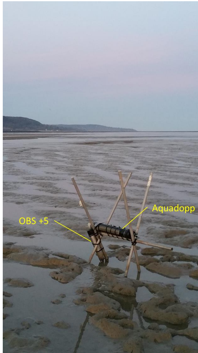
Figure 29 Photographie de l'Aquadopp (implanté de façon horizontale dirigé vers le chenal) et l'OBS-5+ (fixé sur un des mats avec les capteurs regardant vers le haut) (Photo : Vennin, 2017)
