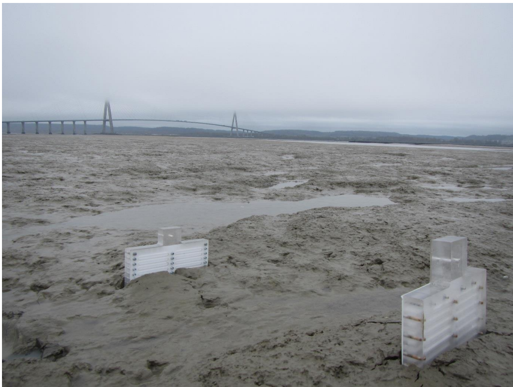
Figure 12 Dialyseur in-situ avec en arrière-plan le pont de Normandie. La partie émergente du dialyseur est de l'ordre de 10 centimètres de haut. (Cliché : Vennin, 2016)
