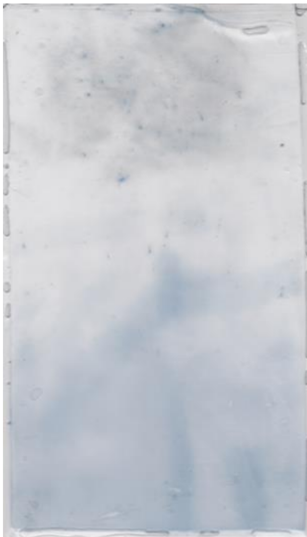
Image originale du DET de la Figure 51-b présentant dans sa partie supérieure une coloration grisée provoquée par la contamination du réactif
