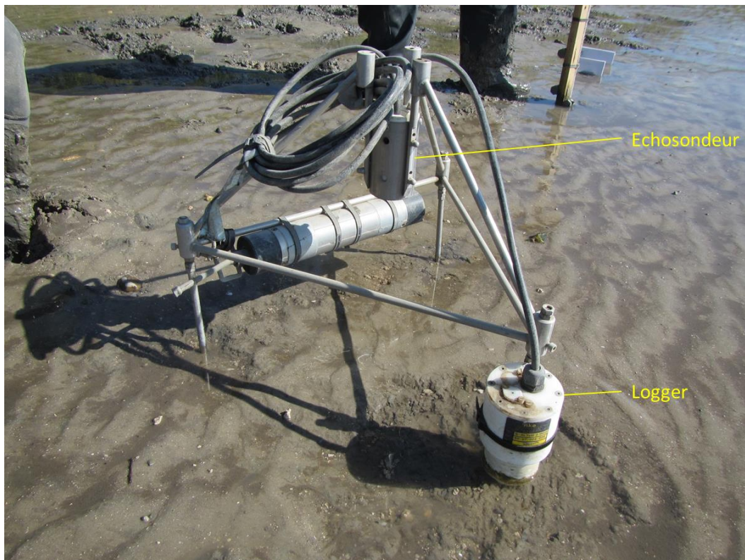
Figure 28 Photographie de l'Altus in-situ avec en haut : l'échosondeur et au niveau du pied : le logger (en blanc). (Instrument fixé de façon horizontale est un turbidimètre) (Photo : Vennin, 2017)
