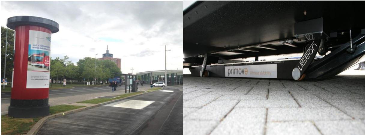
Figure 2.6: L'emplacement du primaire sous le sol et la tour de refroidissement du primaire [12] (à gauche) et la bobine secondaire [13] (à droite) – Bombardier Primove
