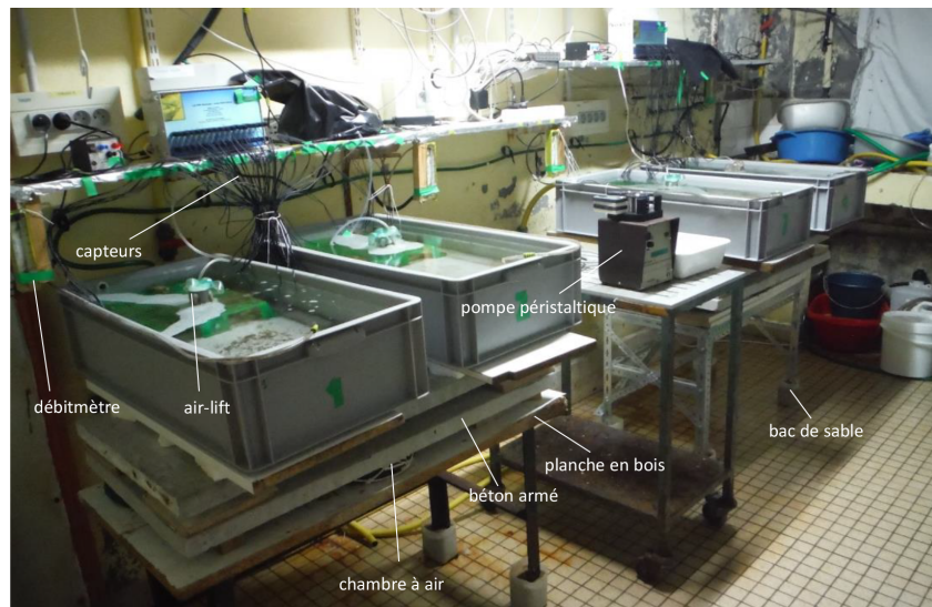
FIGURE 3.5 – Vue générale du dispositif utilisé lors d'exposition des huîtres au bruit couplé à une contamination métallique.
