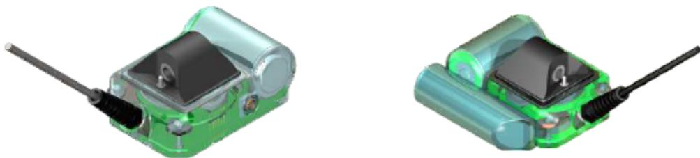
**Figure 2.7: Balise CTD-SRDL et CTD/fluor-SRDL** – À gauche le modèle classique de CTD-SRDL et à droite le modèle avec fluorimètre. Dimensions du modèle classique :  $10.5 \times 7 \times 4$  cm. Crédit : SMRU Instrumentation
