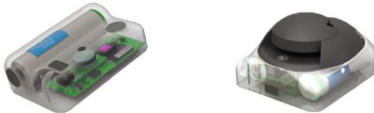
Figure 2.8: Balises MK10-X et TDR10-DD – MK10-X à gauche et TDR10-DD à droite. Ces balises mesurent respectivement 5.6 \times 3.8 \times 2 cm et 7.4 \times 5.7 \times 3.6 cm. Crédit : Wildlife Computers
