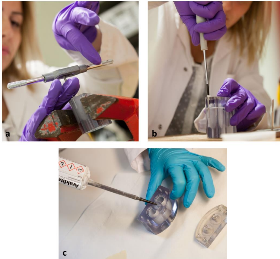
Figure 2.7. Illustration des solutions techniques développées : (a) taroudage du système de fixation de la partie basse de l'insert, (b) vissage et (c) collage des deux parties de l'insert.
