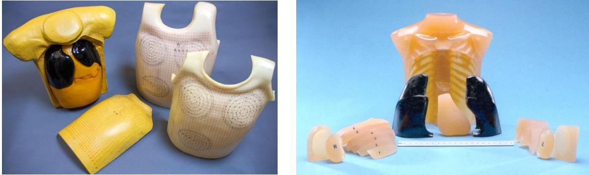
Figure 1.7. Fantômes d'étalonnage pulmonaire : (à gauche) le fantôme LIVERMORE avec ses différentes plaques extrathoraciques, (à droite) le fantôme JAERI et ses différents éléments.
