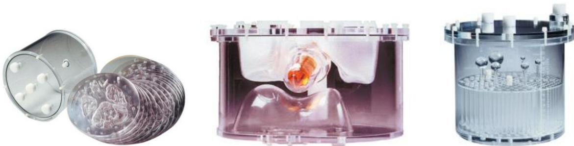
Figure 1.10. Illustrations (de gauche à droite) du fantôme cerveau 3D HOFFMAN, du fantôme TORSO équipé de l'insert cardiaque et du fantôme Jaszczak (Orion, 2018).
