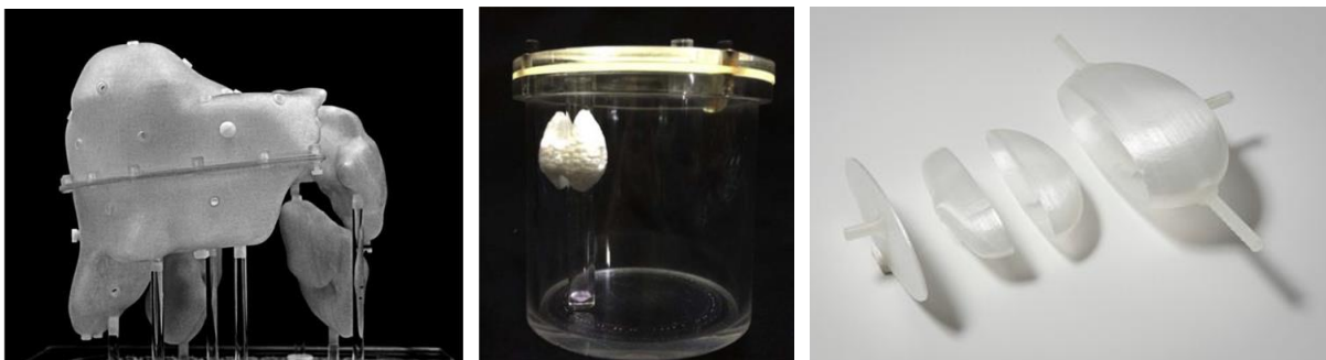
Figure 1.15. Illustration de quelques fantômes développés par impression 3D : (de gauche à droite) le fantôme de foie, incluant des nodules, développé par (Gear et al. , 2014), le fantôme thyroïdien développé par (Alssabbagh et al. , 2017a) et le fantôme de reins comprenant différents compartiments développé par (Tran-Gia and Lassmann, 2018).
