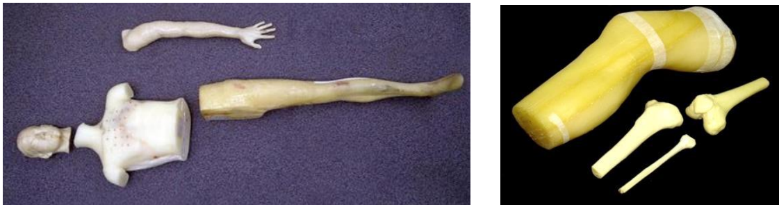
Figure 1.9. (à gauche) Les fantômes USTSUR composés du fantôme tête, torse, bras et jambe, (à droite) le fantôme jambe Spitz.
