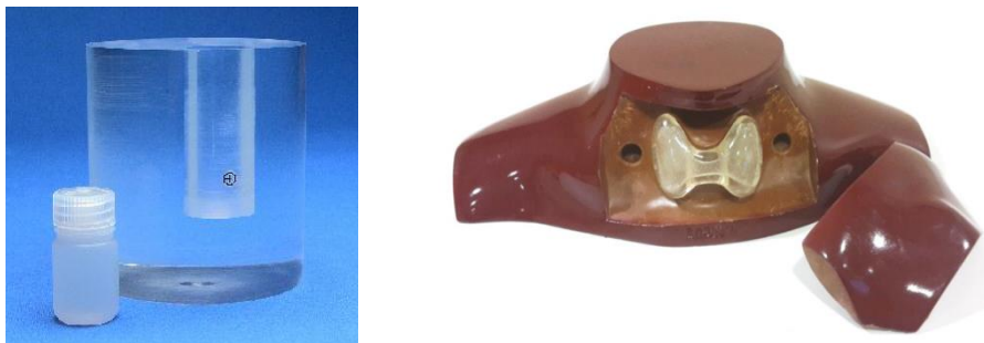
Figure 1.8. Fantôme d'étalonnage thyroïdien (à gauche) IAEA/ANSI et (à droite) RSD.
