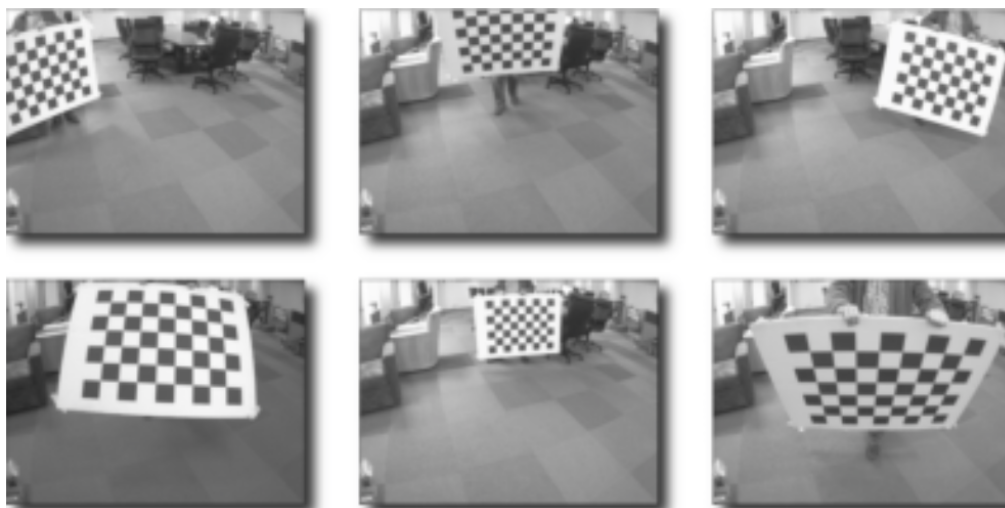
FIGURE 3.13 – CALIBRATION DES CAMÉRAS — Echiquier géant utilisé lors de la calibration des caméras en configuration stéréoscopique.
