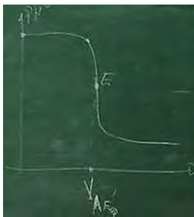
Figure 62: allure de la courbe de dosage d'un acide fort par une base forte
