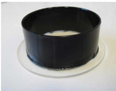
FIGURE 2.15: Photographie du montage d'immersion dans l'huile utilisé pour la rhéomicroscopie.
