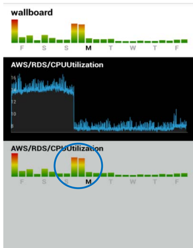
Figure 44. Exemple 2 d'anomalies détectées par Grok
