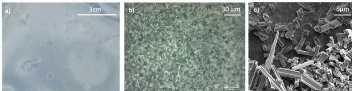
**Figure 27:** Images de couches de GaN dégradées par un recuit à haute température (1100 °C) à différents niveaux d'observation : a) photographie macroscopique, b) image de microscopie optique et c) image de microscopie électronique (MEB).
