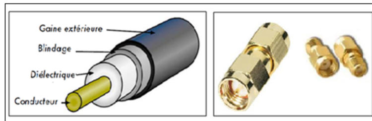
FIGURE I.10 – Structure d'un câble coaxial et connecteurs de type SMA
