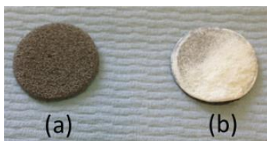
Figure II-20 Rondelle de fritté de nickel (a) avant frittage, (b) après frittage. L'échantillon de silice reste en partie fortement accroché sur le fritté.
