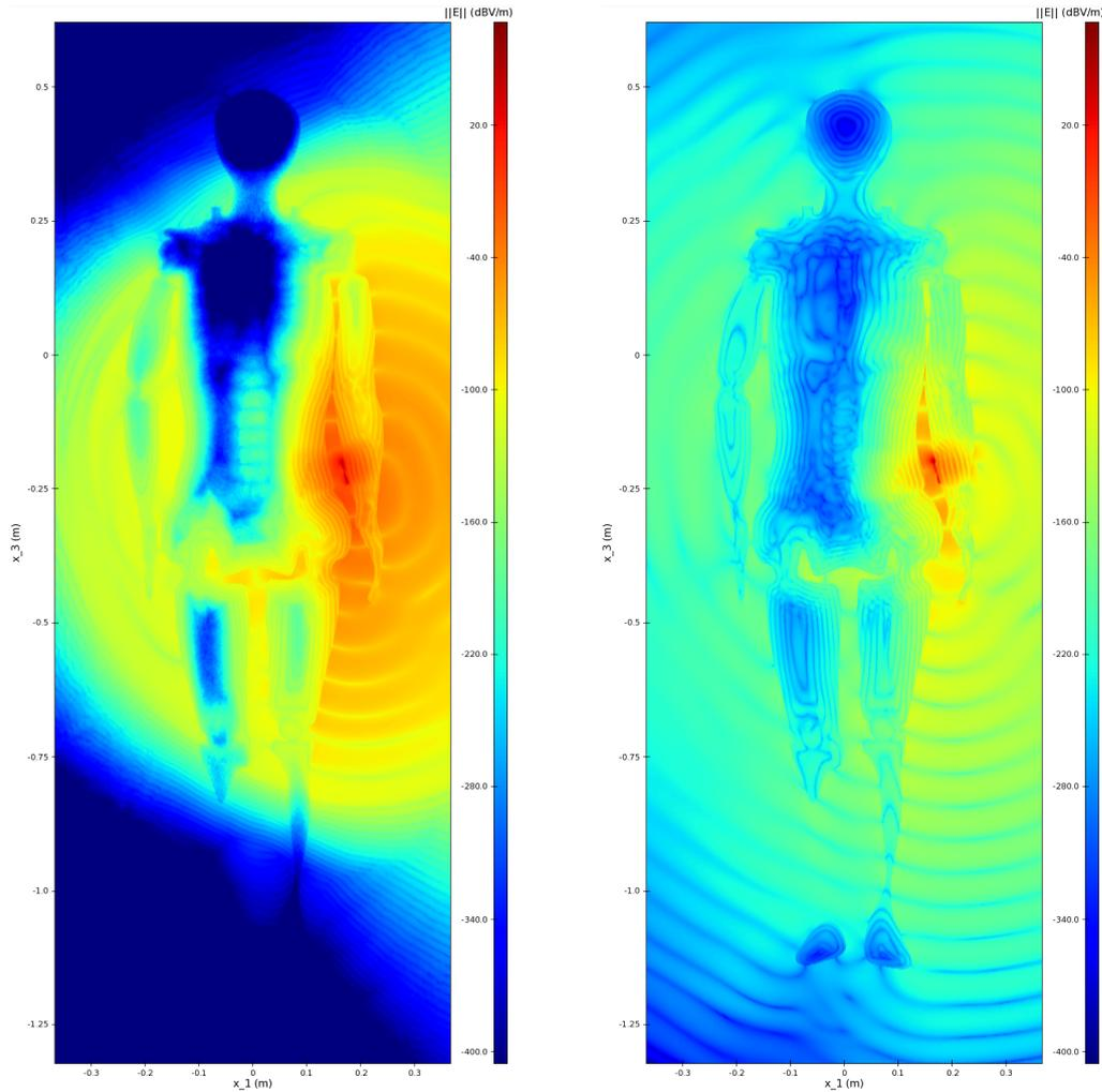
Nous pouvons constater la compression de la longueur d'onde dans les matériaux de forte permittivité et leur absorption par les tissus présentant une conductivité électrique non nulle. Les ondes étant plus rapides dans le vide, elles pénètrent dans le corps du côté droit (opposé à l'antenne) avant l'arrivée des ondes qui le traversent de part en part dans le sens gauche-droite.
