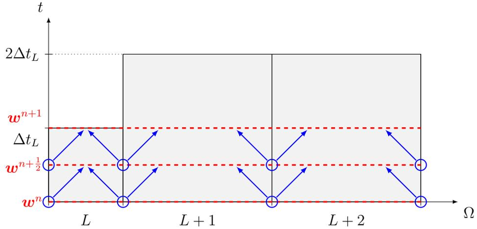
FIGURE 5.4 – Calcul d'un pas de temps LRK2 dans une configuration de mailles hétérogènes. Les étapes dans le calcul de la solution sont en pointillés rouges. Le calcul des flux dans l'opérateur  $\mathcal{G}$  est représenté par les cercles bleus et leur application via l'avancée en temps par les flèches bleues. Le calcul des flux locaux dans l'opérateur  $\mathcal{G}_l$  est représenté par les demi-disques verts et leur application via l'avancée en temps par les flèches vertes.
