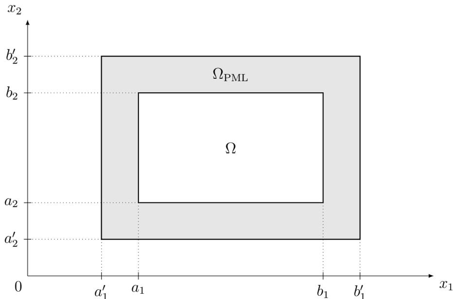
Considérons les équations de Maxwell dans le domaine de calcul  $\Omega = [a_1; b_1] \times [a_2; b_2] \times [a_3; b_3]$  inclus dans  $\mathbb{R}^3$ . Soit aussi le volume englobant  $\Omega_{\text{PML}} = [a'_1; b'_1] \times [a'_2; b'_2] \times [a'_3; b'_3]$  défini tel que dans chaque direction  $a_i > a'_i$  et  $b_i < b'_i$  (figure 2.1). Il est possible d'établir des modèles PML pour des domaines de formes plus complexes comme par exemple dans les travaux de Laurens [49].
