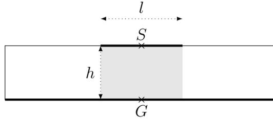
La surface du générateur comprise entre la ligne microruban et le plan de masse possède une impédance réelle dont la valeur est donnée par la résistance  $R_T$  du générateur de Thévenin :
