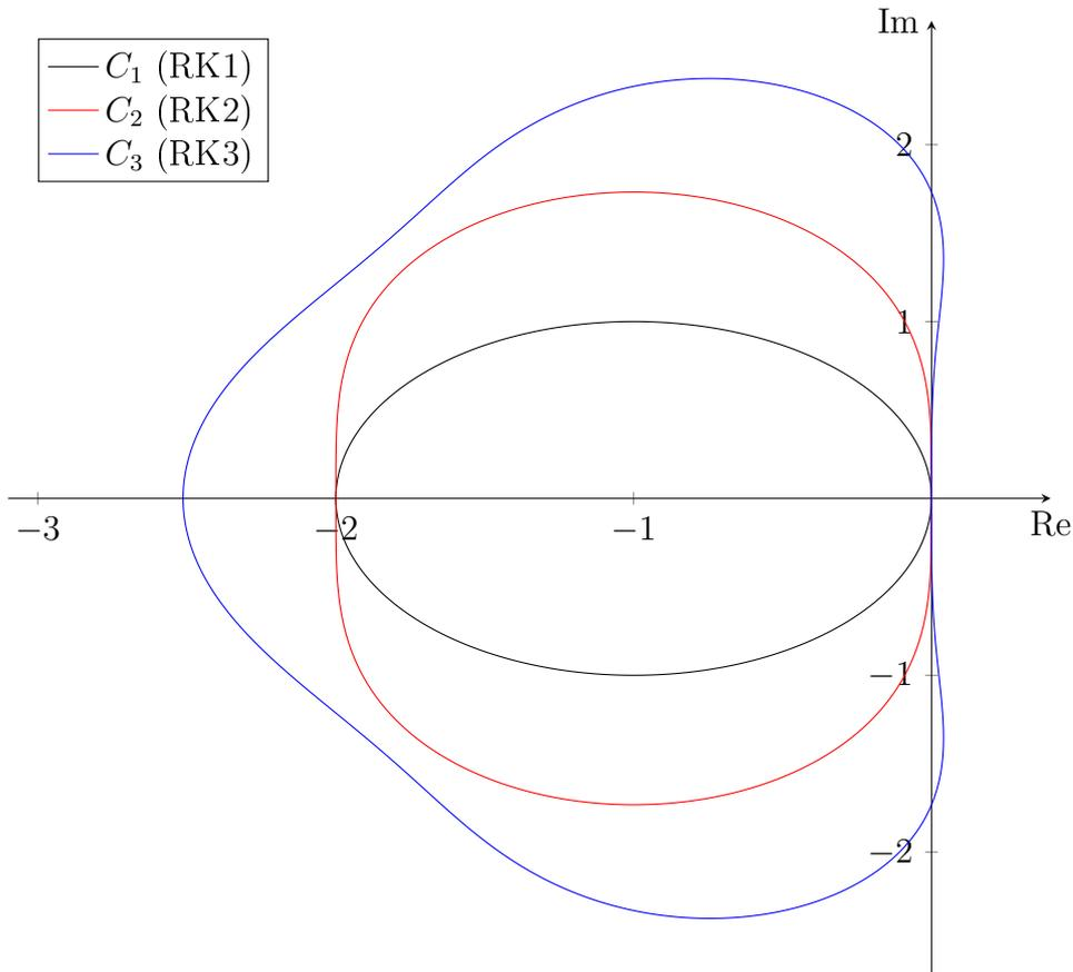
temps plus petit permet alors de rapprocher les valeurs propres de l'axe réel jusqu'à les inclure dans la zone de stabilité. Dans le cas du schéma RK3, la zone de stabilité est tangente à l'axe imaginaire dans le demi-plan des parties réelles positives, englobant une partie de l'axe imaginaire, ce qui permet de fortement relâcher la contrainte sur le choix du pas de temps.
