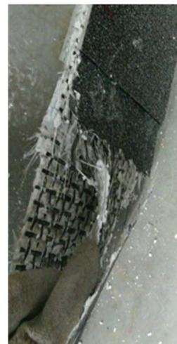
Figure V-29. Modes de rupture des éprouvettes de composite MA,MatAR-2.12K-S
