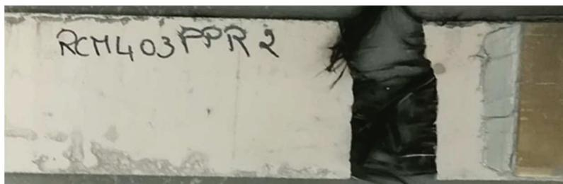
Figure VII-13: Rupture du TRC-Refratex
