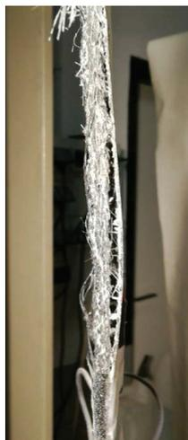
Figure V-28. Mode de rupture des éprouvettes de composite MA,MatAR-2.12K-H
