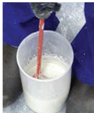
Figure V-1 : Mélange du liant phosphatique (SULITEC)
