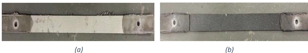
Figure III-11: L'éprouvette TRC (a) avant et (b) après l'application de mouchetis
