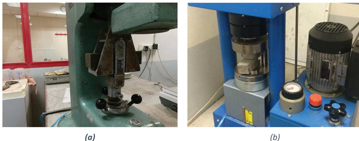
Figure IV-2 : Caractérisation du mortier à l'état durci : (a) essai de flexion 3 points caractérisant la résistance en traction du mortier ; (b) essai caractérisant la résistance en compression du mortier
