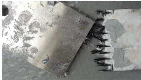
Figure V-32 : Rupture du composite MA,MatAR-2.12K-X
