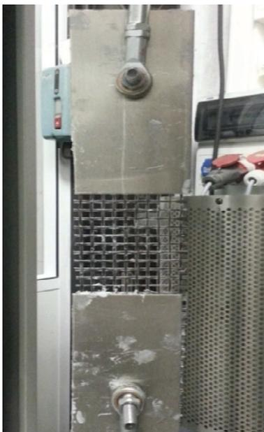
Figure V-14 : Essais de traction de la grille de carbone 2\*6K
