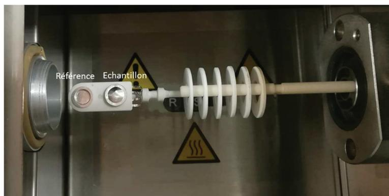
Figure VI-6 : Montage d'essai ATG-DSC
