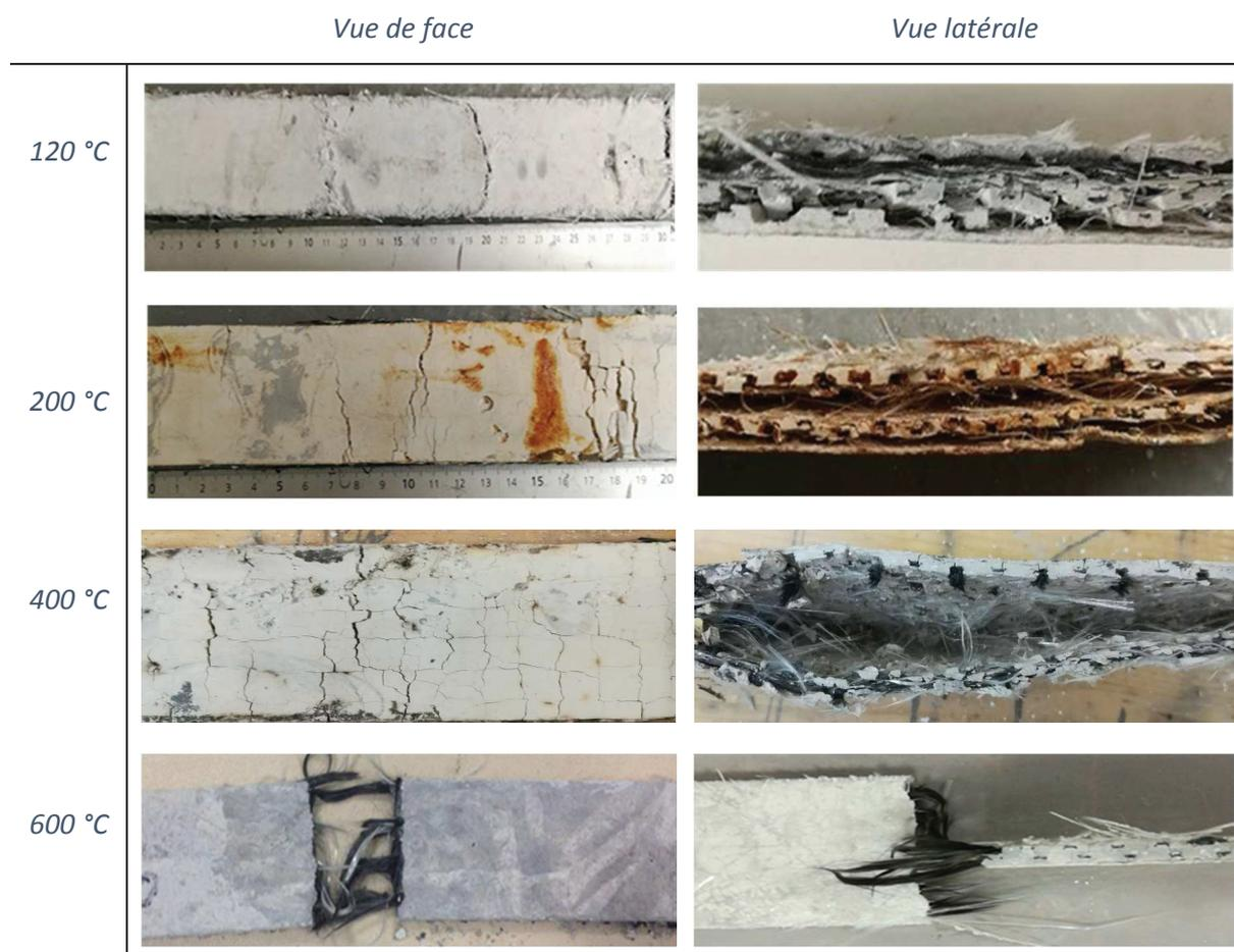
Figure V-34. Mode de rupture de MA, MatAR-2.12K-X aux différents niveaux de température (120 °C, 200 °C, 400 °C, 600 °C)
