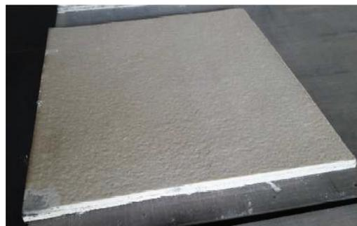
Figure VII-6: Composite recouvert d'Insulfrax (SULITEC)
