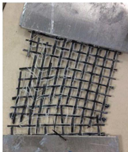
Figure V-15 : Rupture de la grille de carbone 2\*6K
