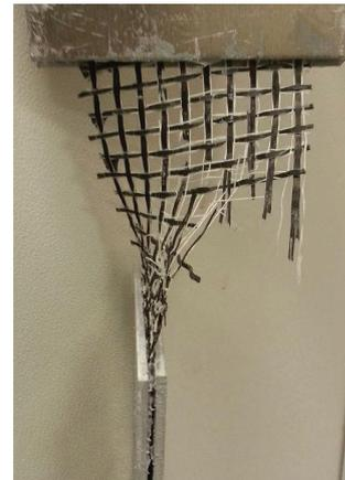
Figure V-24 : La rupture de la grille carbone 12K
