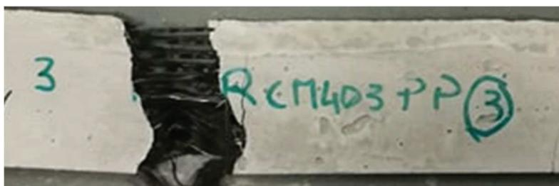
Figure VII-12: Rupture du TRC
