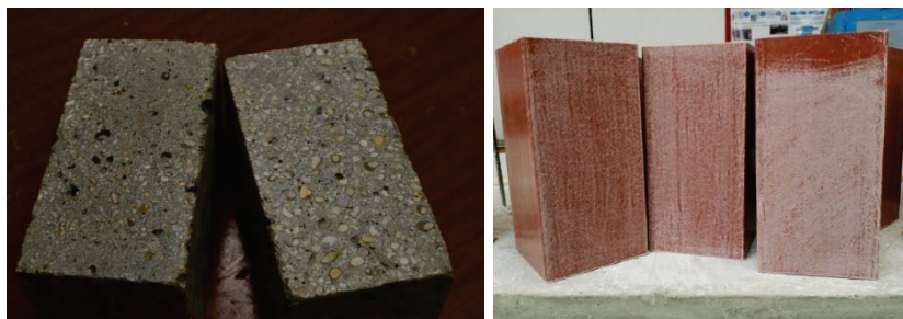
Figure II-5 : Ponçage du béton et du pultrudé
