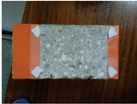
Figure II-33 : Utilisation de cales en plastique pour la série POCB16
