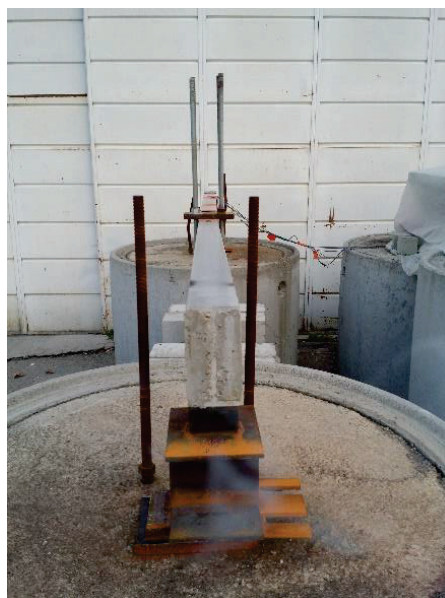
Figure IV-28 : Déversement du profilé pultrudé
