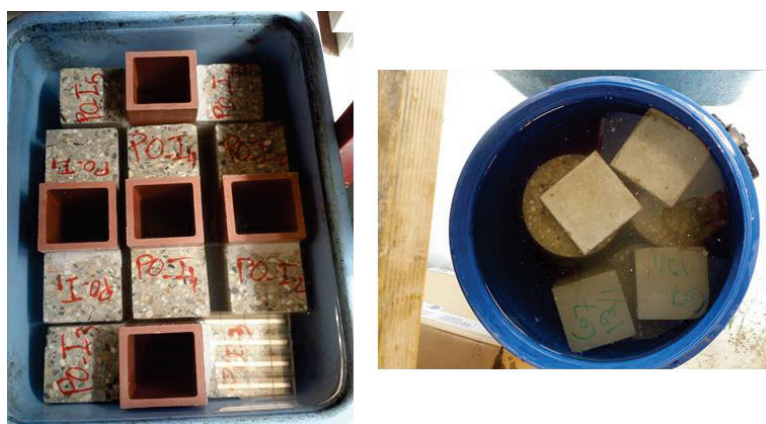
Figure II-14 : Vieillissement par immersion dans l'eau douce
