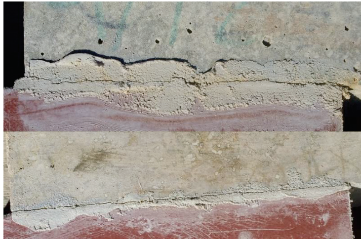
Figure II-63 : Développement des fissures à l'interface béton/colle après 10 mois d'immersion dans l'eau
