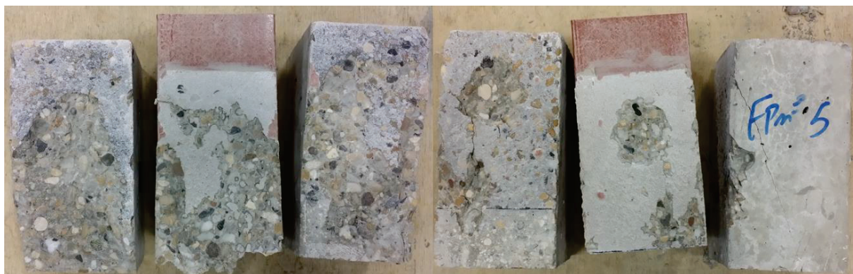
Figure II-76 : Faciès de ruine des éprouvettes vieilles naturellement pendant 1 an (série POCB13)
