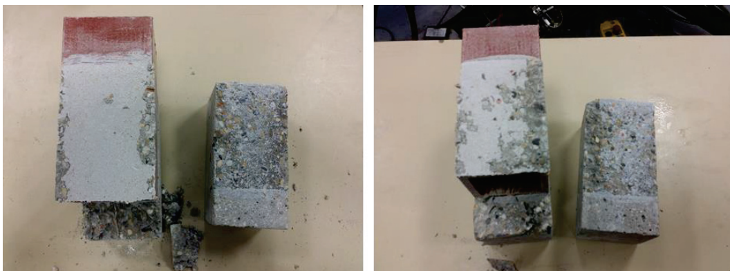
Figure II-47: Modes de rupture des éprouvettes vieilles par humidification (série POCB3)
