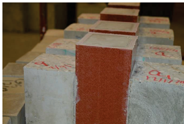
Figure II-9 : Bétonnage des raidisseurs
