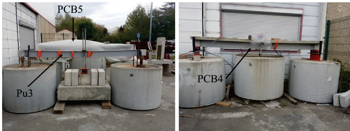
Figure IV-24 : Poutres chargées durant le deuxième essai de fluage (PCB4, PCB5, Pu3)
