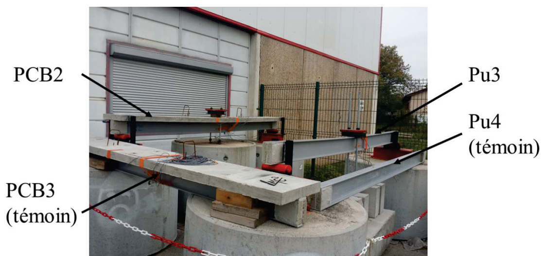
Figure IV-23 : Poutres chargées et non chargées durant le premier essai de fluage (PCB2, PCB3, Pu3 et Pu4)
