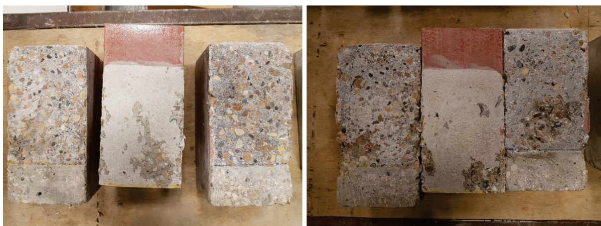
Figure II-77 : Faciès de ruine des éprouvettes vieilles naturellement pendant 20 mois (série POCB14)
