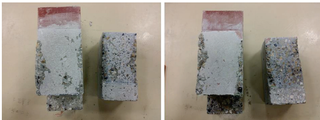
Figure II-48: Modes de rupture des éprouvettes vieilles par immersion (POCB4)
