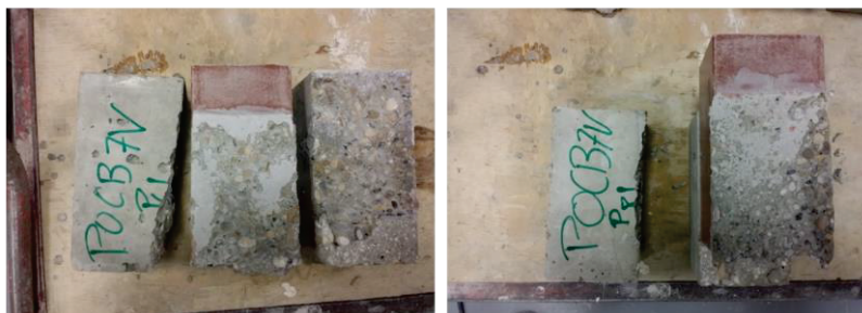
Figure II-72 : mode de ruine des éprouvettes : (a) non vieilles (POCB7nv) et (b) vieilles (POCB7v)
