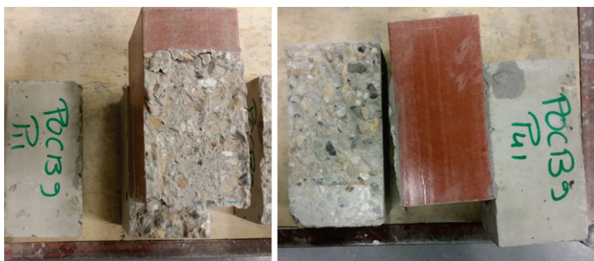
Figure II-32 : Surfaces rompues des éprouvettes push out POCB9
