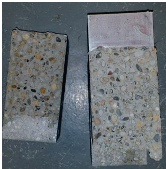
Figure B. 4 : Mode de ruine typique des éprouvettes POCB5 non rectifiées
