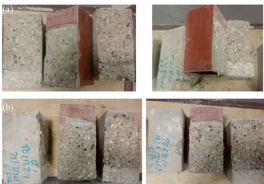
Figure II-39 : Modes de ruine des éprouvettes (a) POCB22 (sans rectification de dalles) et (b) POCB21 (avec rectification de dalles)
