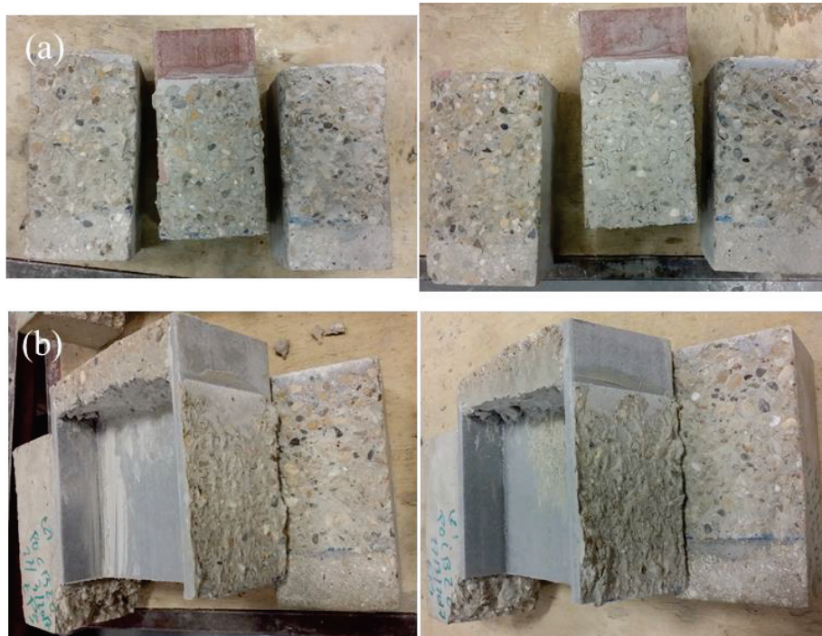
Figure II-45 : Modes de ruine des éprouvettes (a) POCB19 (tube pultrudé) et (b) POCB20 (profilé en I)
