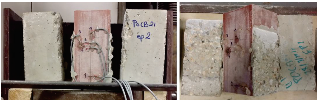
Figure III-35 : mode de ruine de l'éprouvette n°2 de la série POCB21
