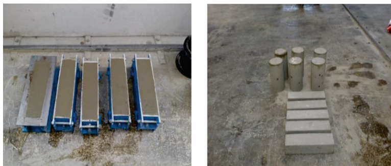
Figure II-4 : coulage et démoulage des prismes de béton
