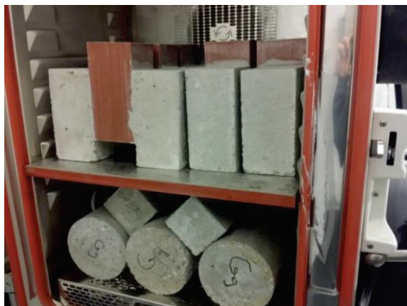
Figure II-15 : Vieillissement par exposition aux cycles gel/dégel
