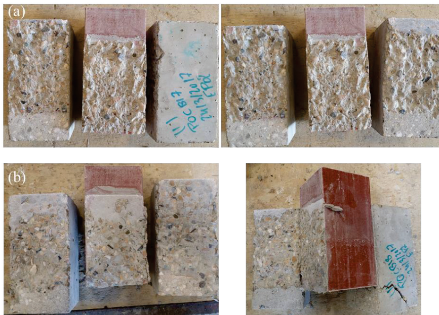
Figure II-43 : Modes de ruine des éprouvettes (a) POCB17 (plaque de chargement) et (b) POCB18 (plaque avec cylindre)
