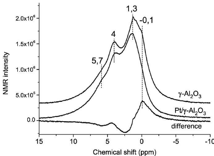
Figure 21. Spectres RMN  $^1\text{H}$  de  $\gamma\text{-Al}_2\text{O}_3$  et  $\text{Pt}/\gamma\text{-Al}_2\text{O}_3$  et spectre différence.<sup>43</sup>
