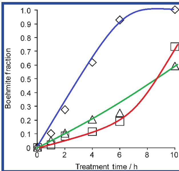
Figure 20. Cinétique de formation de boehmite durant un traitement hydrothermal sous agitation constante à 200°C à partir : i) d'une alumine pure (losanges) et ii) de catalyseurs 1 wt% Pt/ $\gamma$ -Al<sub>2</sub>O<sub>3</sub> (triangles) et 1 wt% Ni/ $\gamma$ -Al<sub>2</sub>O<sub>3</sub> (carrés).<sup>38</sup>.
