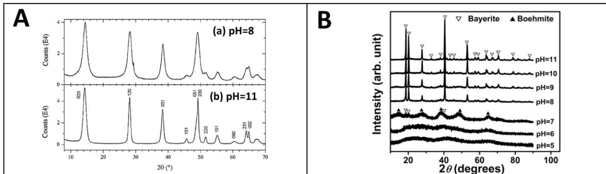
Figure 3. (A) Diffractogrammes de RX des particules de boehmite synthétisées à : (a) pH=8, (b) pH=11 et vieillies durant 2 semaines à 100°C,<sup>14</sup> et (B) Diffractogrammes de RX des hydroxydes d'aluminium précipités à différentes valeurs de pH avec un vieillissement de 12 h à température ambiante.<sup>15</sup>
