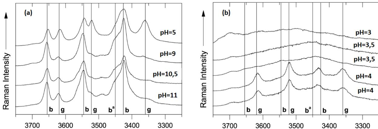
*Figure 9 (adaptée). Spectres Raman de l'alumine gamma en suspension dans l'eau sur une table à secousses à 25°C pour différentes valeurs de pH. b: bayerite, g: gibbsite.<sup>20</sup> Les quatre échantillons notés pH 3.5 et pH 4 correspondent à des tests de reproductibilité. Spectres obtenus sur une poudre séchée à 110°C après un lavage visant à éliminer les molécules et les ions adsorbés.*
