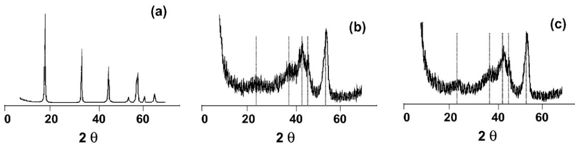
Figure 27 (adaptée). Diffractogrammes de RX de différentes alumines suite à un traitement hydrothermal à 300°C. (a) alumine  $\gamma$ , (b) alumine  $\gamma$  dopée au 2% P et (c) alumine  $\gamma$  dopée au 2%  $F^{61}$ .
