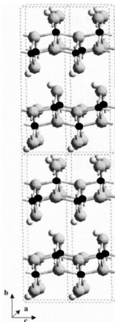
*Figure 2. Structure de la boehmite  $\gamma$ -AlOOH. Grandes boules foncées: oxygène, petites boules noires : aluminium et petites boules blanches: hydrogène.<sup>5</sup>*
