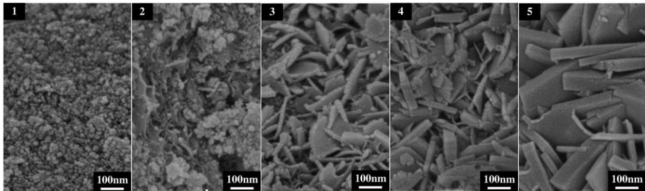
*Figure 17. Clichés MEB d'une alumine gamma à l'état initial (1) puis ayant subi un traitement hydrothermal à 140°C sous agitation durant : (2) 1 h, (3) 2 h, (4) 6 h et (5) 24 h.<sup>36</sup>*
