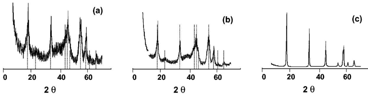
*Figure 33 (adaptée). Diffractogrammes de RX d'une alumine suite à un traitement hydrothermal à 300°C en présence de (a) 25% de phénol dans l'eau, (b) 25% d'acide acétique dans l'eau et (c) de l'eau pure.<sup>61</sup>*
