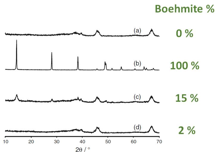
*Figure 30 (adaptée). Diffractogrammes de RX de catalyseurs 1 wt % Pt/Al<sub>2</sub>O<sub>3</sub> (a) non traité (état initial) et ayant subi un traitement hydrothermal à 225°C durant 10h dans (b) l'eau et des solutions avec : (c) 5 wt% glycérol et (d) 5 wt % sorbitol. La quantification de la boehmite formée est fondée sur une combinaison linéaire des spectres RMN <sup>27</sup>Al de l'alumine pure et de la boehmite pure.<sup>68</sup>*
