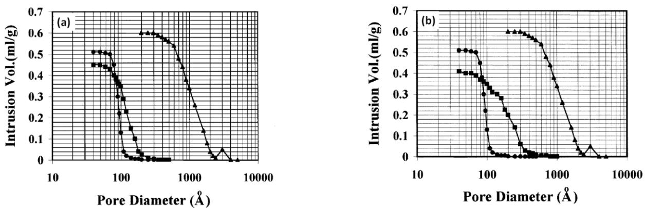
*Figure 32. Effet (a) du phénol et (b) de l'acide acétique sur la taille des pores d'une alumine  $\gamma$  suite à un traitement hydrothermal à 300°C. ● Alumine  $\gamma$  non traitée, ▲ traitée sous conditions hydrothermales dans l'eau pure et ■ traitée sous conditions hydrothermales avec 25% de phénol ou d'acide acétique dans l'eau.<sup>61</sup>*
