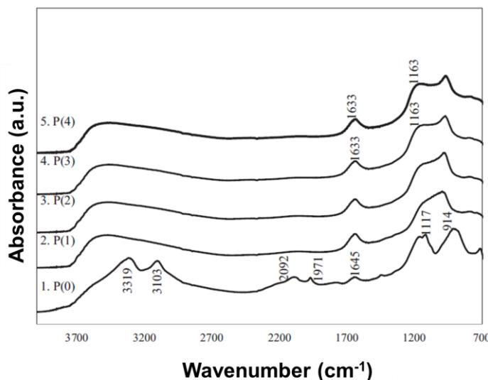
*Figure 26. Spectres IR de catalyseurs Co/\gamma-Al<sub>2</sub>O<sub>3</sub> dopés par des ions phosphate ayant subi un traitement hydrothermal à 230°C sous agitation durant 120h. Les catalyseurs sont nommés P(x) où x représente la teneur massique en phosphore.*<sup>56</sup>
