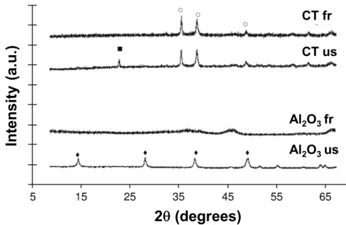
*Figure 31. Diffractogrammes de RX d'une  $\gamma$ -Al<sub>2</sub>O<sub>3</sub>, avant (fr) et après (us) utilisation, catalyseur au cuivre recouvert de PTFE (CT), avant (fr) et après (us) utilisation. Réacteur à ruissellements (trickle bed reactor) à une pression de 7 atm en O<sub>2</sub>, 140°C, débit de l'eau 1 mL/min. Catalyseurs utilisés dans des expériences successives jusqu'à 80h. (○ : CuO ; ■ Cu(C<sub>2</sub>O<sub>4</sub>)·0,4H<sub>2</sub>O ; ◆ boehmite).<sup>73</sup>*
