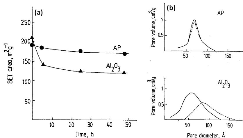
Figure 25. Influence d'un traitement thermique sous vapeur d'eau à 750°C durant 48h pour une  $\text{Al}_2\text{O}_3 \gamma$  et un aluminophosphate sur : (a) la surface BET en fonction du temps et (b) la distribution de taille des pores ,avant (ligne continue) et après (ligne discontinue) traitement sous vapeur d'eau.<sup>55</sup> AP : aluminophosphate. Le traitement est fait dans un four avec un débit d'eau de 2,5 mL/min
