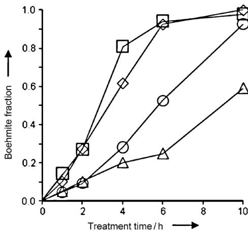
Figure 22. Cinétique de formation de boehmite durant un traitement hydrothermal à 200°C de : i)  $\gamma\text{-Al}_2\text{O}_3$ , ○ Pt-OH, △ Pt-Cl et □ Pt-com (catalyseur commercial Pt/ $\gamma\text{-Al}_2\text{O}_3$  Alfa Aesar).<sup>53</sup>
