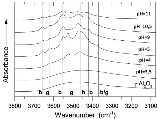
*Figure 10 (adaptée). Spectres IR de l'alumine gamma en contact avec l'eau sur une table à secousses à 25°C à différentes valeurs de pH. b: bayerite, g: gibbsite.<sup>20</sup> Spectres obtenus sur une poudre séchée à 110°C après un lavage visant à éliminer les molécules et les ions adsorbés.*
