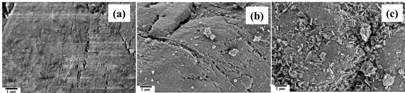
Figure 14. Clichés MEB d'une alumine  $\gamma$  : (a) à l'état initial puis ayant subi une hydratation en solution à température ambiante sous agitation durant : (b) 2 semaines et (c) 6 mois.<sup>21</sup>
