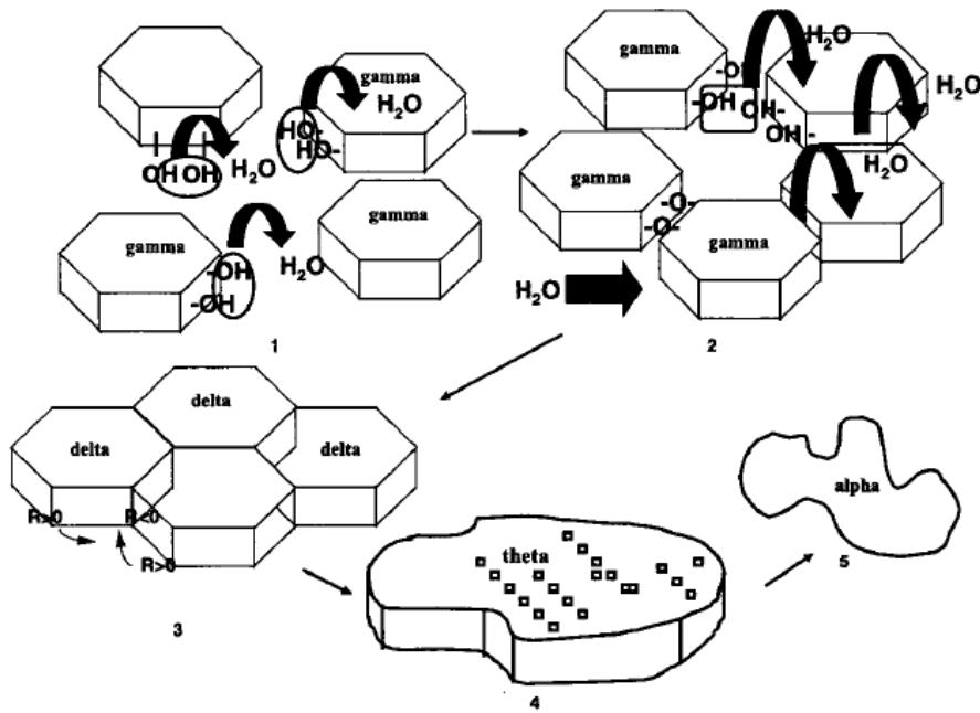
Figure 7. Schéma simplifié de la transition  $\gamma \rightarrow \delta \rightarrow \theta \rightarrow \alpha$  : 1: déshydroxylation de  $\gamma\text{-Al}_2\text{O}_3$ ; 2 : formation de ponts Al-O-Al entre plaquettes ; 3:  $\gamma \rightarrow \delta\text{-Al}_2\text{O}_3$  ; 4 : évolution vers  $\theta\text{-Al}_2\text{O}_3$  avec formations des lacunes ; 5 : transformation en  $\alpha\text{-Al}_2\text{O}_3$ .<sup>5</sup>
