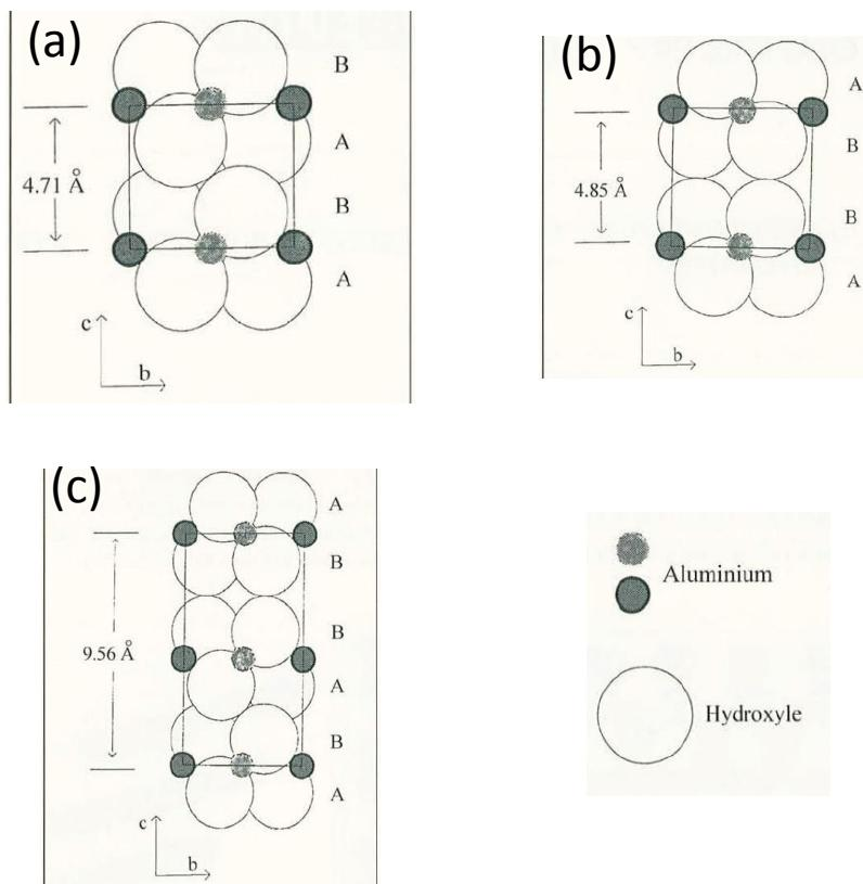
Figure 1. Séquence d'empilement des feuillets pour les différents hydroxydes d'aluminium.
