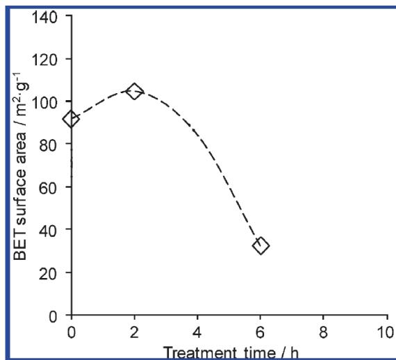
*Figure 18 (adaptée). Variation de la surface spécifique mesurée par physisorption de  $\text{N}_2$  pour une alumine  $\gamma$  traitée en phase aqueuse en conditions hydrothermales à 200°C en fonction du temps du traitement (agitation continue, 0,5g de solide dans 30 mL d'eau ionisée).<sup>38</sup>*
