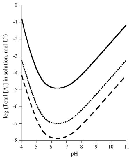
Figure 11. Profils de solubilité pour l’alumine gamma (ligne continue), bayerite (ligne en pointillés), gibbsite (ligne en tirets). Concentration (échelle log) d’Al (III) dissous en fonction du pH.<sup>9</sup>
