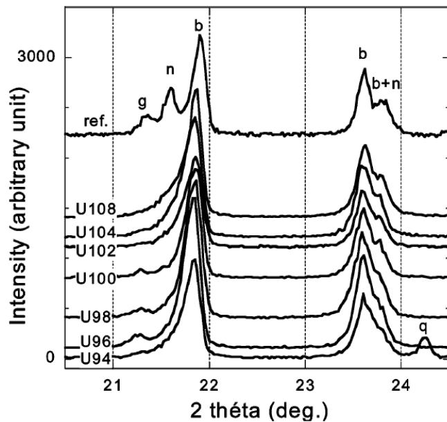
*Figure 4. Diffractogrammes de rayons X des solides obtenus par précipitation à 70°C pour différentes valeurs de pH (9,4-10,8, i.e. U94 à U108). L'échantillon U94 est mélangé avec du quartz comme référence interne (q). Les diffractogrammes sont comparés à un diffractogramme de référence formé d'un mélange de gibbsite (g), nordstrandite (n) et bayerite (b).<sup>16</sup>*
