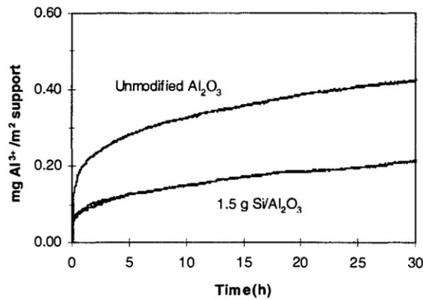
Figure 28. Analyse quantitative de la dissolution d’une alumine et d’une alumine modifiée par Si en conditions de synthèse Fischer-Tropsch (220°C et 20 bar sous agitation).<sup>62</sup>
