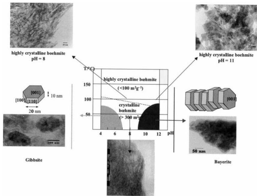
Figure 5. Diagramme de phase pH-température des (oxy)hydroxydes d'aluminium.<sup>5</sup>
