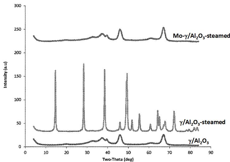
Figure 29 (adaptée). Diffractogrammes de RX de  $\gamma\text{-Al}_2\text{O}_3$  et de  $\text{Mo-}\gamma\text{/Al}_2\text{O}_3$  ayant subi un traitement hydrothermal à 220°C sous 25 bar durant 2 h.<sup>65</sup>
