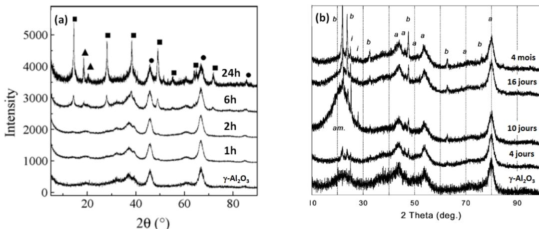
Figure 16 (adaptée). (a) Diffractogrammes de RX d'une alumine  $\gamma$  qui a subi : (a) un traitement hydrothermal à 140°C<sup>36</sup> et (b) une hydratation à température ambiante sous agitation<sup>21</sup> durant différents temps de traitement. ●alumine  $\gamma$ , ■ boehmite et ▲  $\text{Al}(\text{OH})_3$ . a: alumine, b: bayerite, i: impureté et am: phase amorphe.
