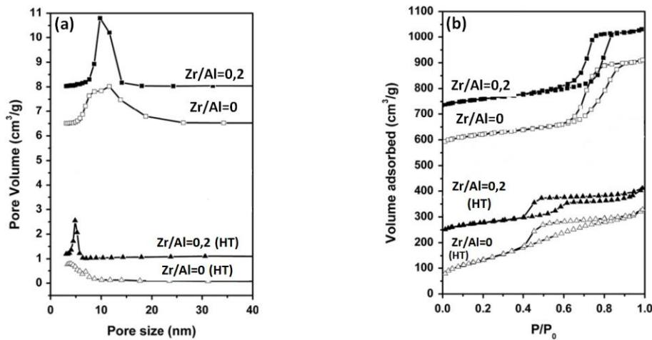
Figure 24 (adaptée). (a) Courbes de distribution de taille des pores et (b) isothermes de physisorption pour des alumines mésoporeuses dopées ou non au Zr, calcinées à 550°C durant 5 h et ayant subi un traitement hydrothermal à 100°C durant 6 h (notées HT).<sup>54</sup>
