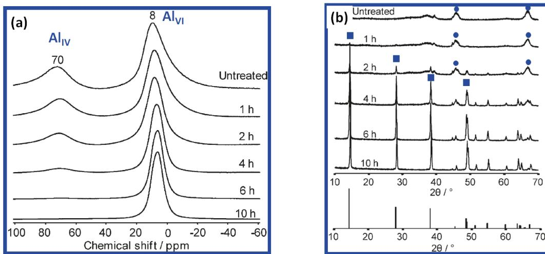
Figure 15 (adaptée). Hydratation à 200°C sous agitation continue dans un autoclave d'une alumine  $\gamma$  et caractérisation : (a) par RMN (b) diffraction des RX.<sup>38</sup> ●  $\gamma\text{-Al}_2\text{O}_3$  et ■  $\text{AlOOH}$ .
