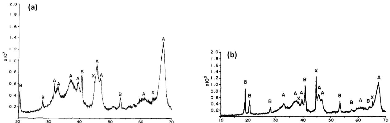
*Figure 12. Diffractogrammes de RX d'une alumine  $\delta$  mise en suspension dans l'eau sous agitation (a) à 20°C durant 4 mois et (b) à 60°C durant 10 jours (pH non précisé).<sup>34</sup> A : alumine, B : bayerite et X : pics de référence de l'aluminium. N.B. Dyer et al.<sup>34</sup> ont indiqué qu'ils travaillent avec une alumine  $\gamma$ , mais les diffractogrammes de RX montrent qu'il s'agit plutôt d'une alumine  $\delta$ .*
