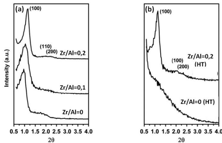
Figure 23 (adaptée). (a) Diffractogrammes de RX d'alumines mésoporeuses dopées au Zr et calcinées à 550°C durant 5h et (b) ayant subi un traitement hydrothermal à 100°C durant 6 h.<sup>54</sup>
