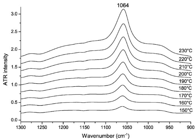
*Figure 13. Spectres IR ATR d'une alumine  $\gamma$  ayant subi un chauffage par paliers de 30 min à chaque température allant de 150°C à 230°C sous 40 bar et un débit de 1 mL·min<sup>-1</sup> H<sub>2</sub>O.<sup>43</sup>*
