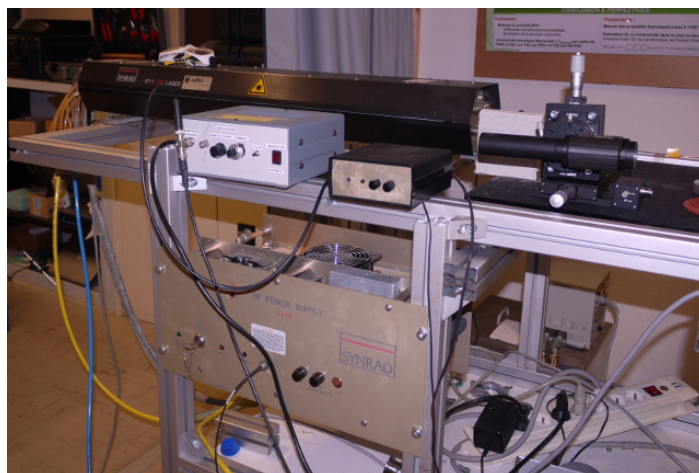
Fig. 7.3 Laser CO 2 continu de classe IV (130 W)
