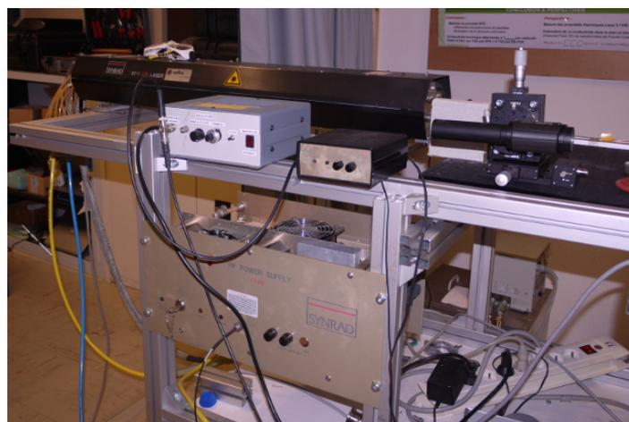
Fig. 7.3 Laser CO<sub>2</sub> continu de classe IV (130 W)
