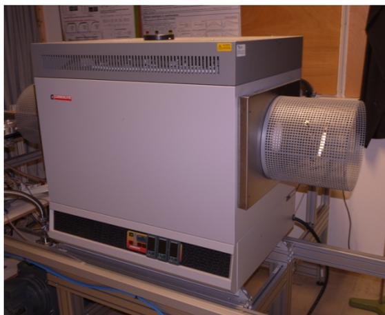
Fig. 7.4 Four tubulaire à haute température
