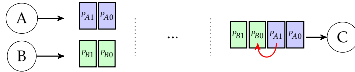
FIGURE 6.10 : Illustration du problème de dépassement de flux.
