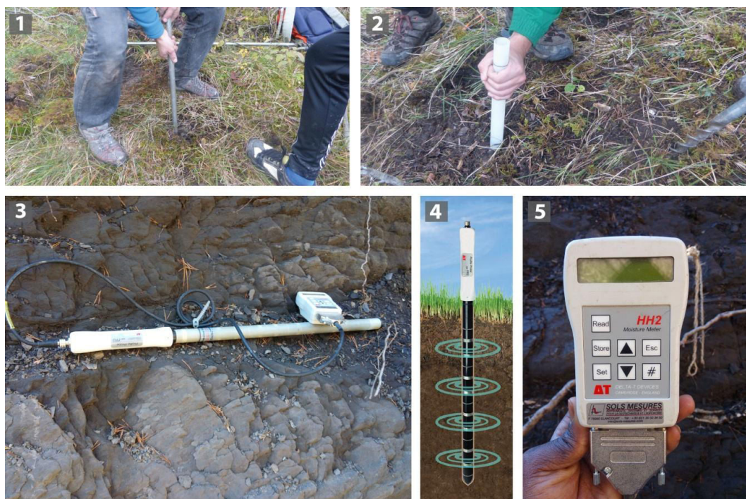
Figure 2.28 : Présentation de l'installation et de la mesure d'une sonde capacitive PR2 (Delta-T ® ). 1/ Réalisation d'un trou à l'aide d'une tarière spécialement conçue pour les tubes PR2. 2/ Insertion du tube d'accueil qui restera enfoui. 3/ Branchement de la sonde PR2 au boîtier de lecture des mesures HH2. 4/ Insertion de la sonde PR2 dans le tube d'accueil après avoir au préalable enlevé la sonde du tube protecteur. 5/ Lecture de la mesure sur le boîtier d'acquisition des données.
