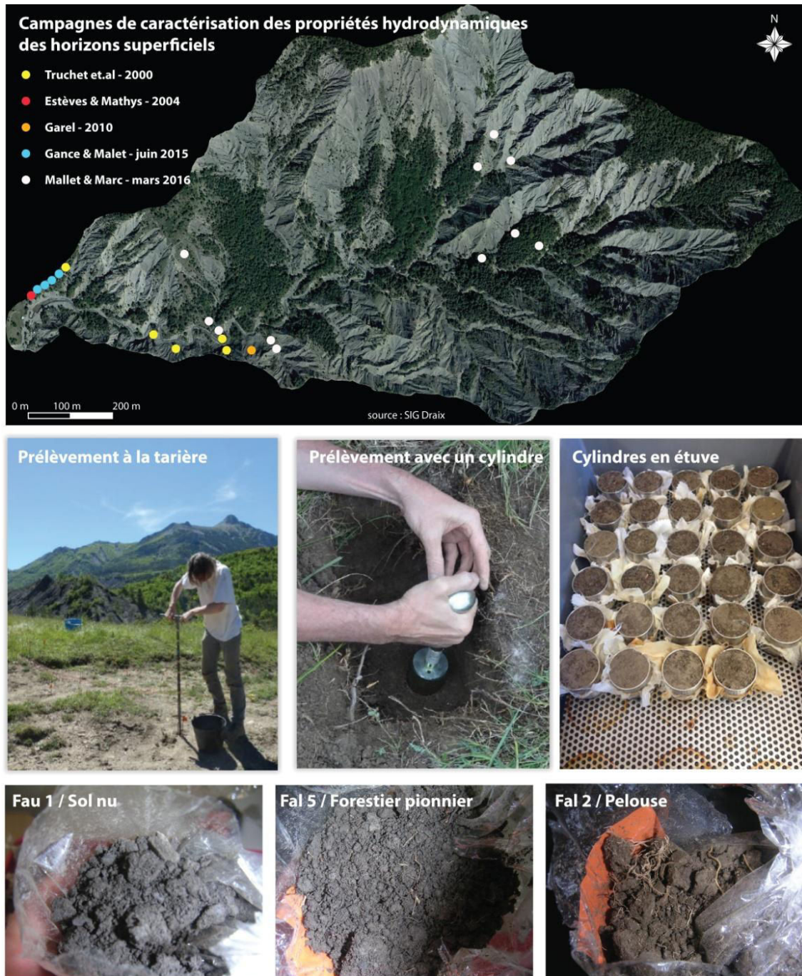
Figure 2.24 : Localisation des sites de prélèvement des échantillons de sol et de mesure d'infiltrométrie in situ au sein du Laval depuis 2000. Les prélèvements de sol sont effectués à l'aide d'une tarière ou d'un cylindre. Les échantillons de sol sont ensuite analysés en laboratoire pour obtenir les propriétés hydrodynamiques des sols.
