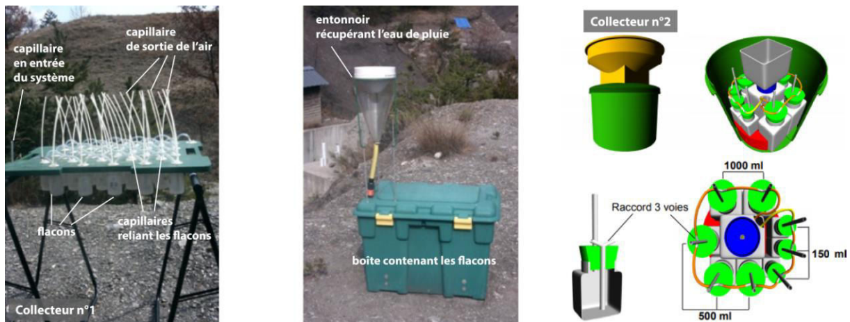
Figure 2.37 : Caractéristiques des deux collecteurs séquentiels de pluie utilisés.
