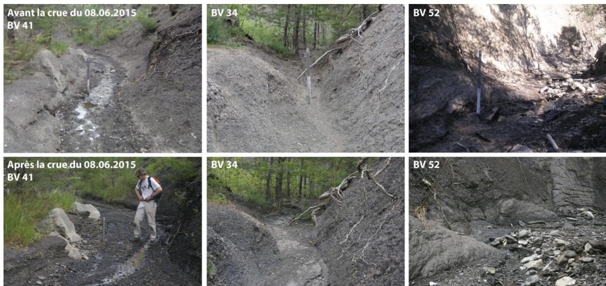
Figure 2.39 : Impacts de la crue du 08.06.2015 sur les stations limnigraphiques à l'exutoire des sous-bassins 41, 34 et 52
