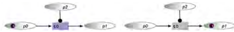
FIGURE 2.10 – État d'un réseau de Petri avant et après le franchissement de transition conditionnée par un arc inhibiteur
